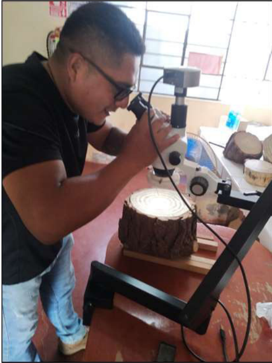
Foto 5. Detección de los anillos de crecimiento, usando estereoscopio con cámara incorporada, para el estudio dendrocronológico
