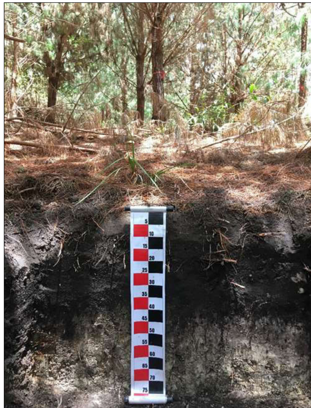
Foto 2. Calicata realizada para estudio de suelo del PPM, de donde se obtuvo la muestra de suelo
