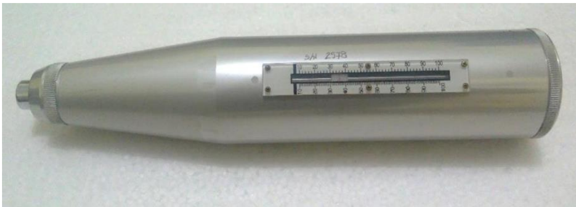
Fotografía N° 16: ESCLERÓMETRO ZHEJIANG TUGONG, propiedad del Laboratorio de Ensayo de Materiales de la Facultad de Ingeniería.
