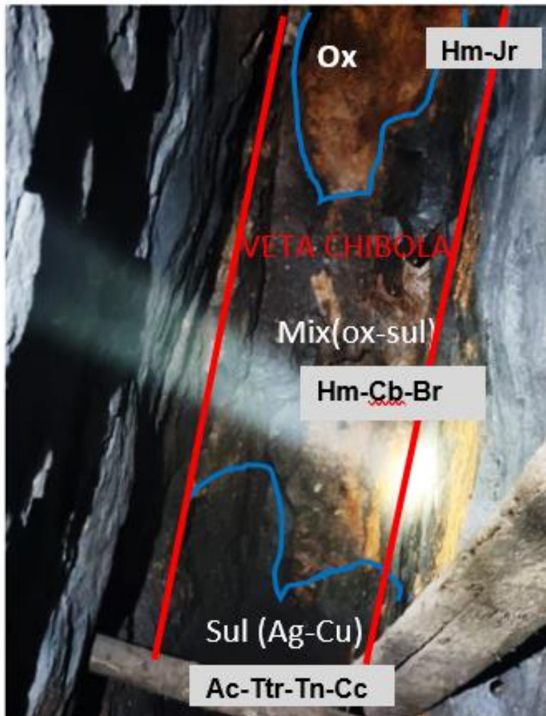
Foto N°24: Veta chibola en SN 7 inferior a 58m. de profundidad de la galería, en la que se visualizan una zona de transacción entre sulfuros y óxidos de potencia 50-60 cm.
