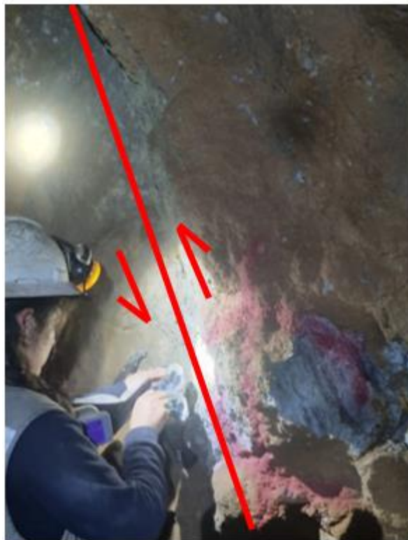
Foto N°8: Falla inversa en roca arenisca cuarzosa de 5 cm. De abertura, con relleno de arcillas y cantidades de sulfuros (pirita) el cual le da el color plumizo.
