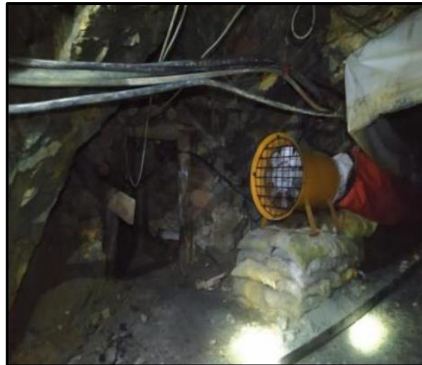
Figura 20. Ventilador axial de 5.5 Hp trifásico Fuente: Nivel 4 – Mina Guty
