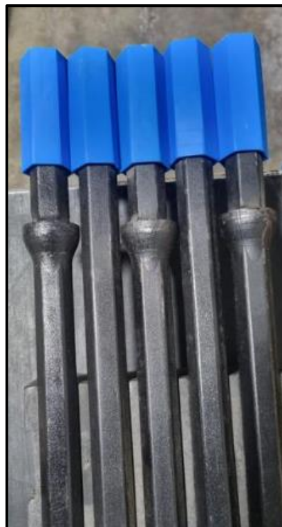
Figura 7. Barrenos cónicos Fuente: Foto de catálogo de importaciones Sudáfrica.
