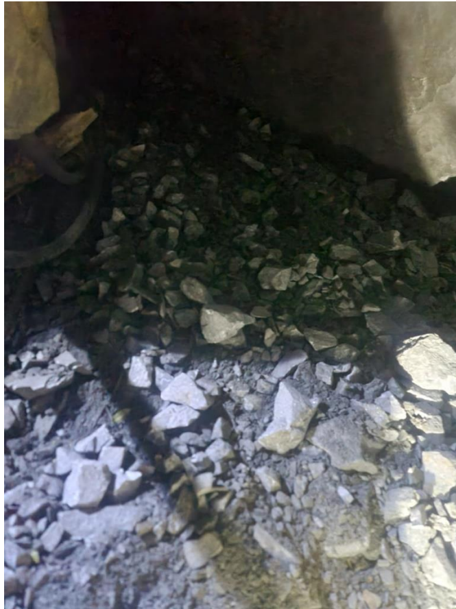
Figura 40. Roca fragmentada después de la voladura con el nuevo diseño
