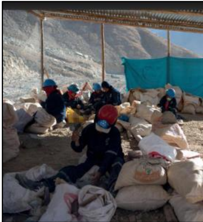
Figura 22. Pallaqueo en pequeña minería Subterránea Fuente: (Orozco, 2016)
