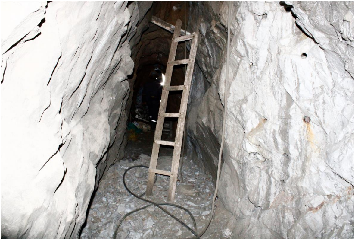
3. Trabajos realizados en forma rudimentaria en la Mina Trinidad II, se observa en el hastial derecho taladros soplados.
