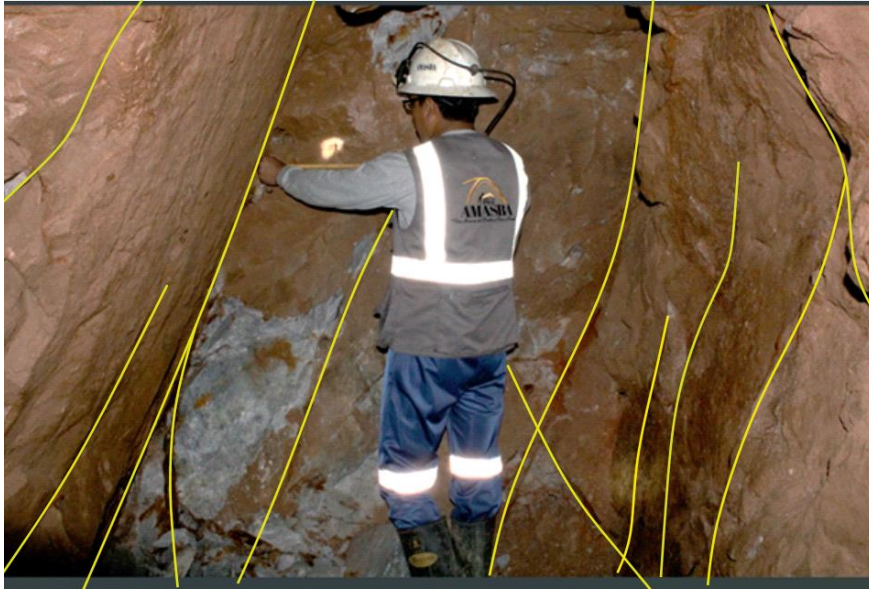
Figura 11 Fracturas de la estación EGP- 02, ubicada en el hastial izquierdo del frente de avance.
