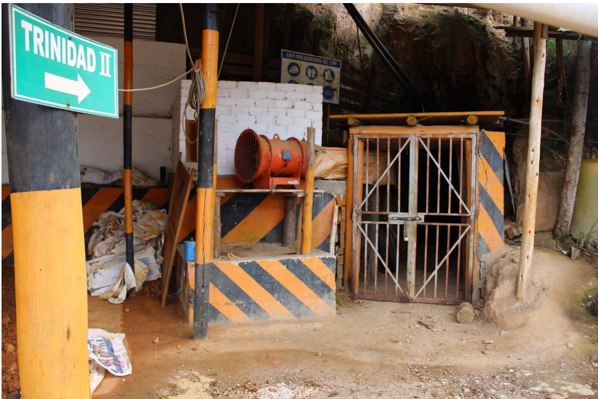
2. Bocamina de la Mina Trinidad II, con señalización de prevención
