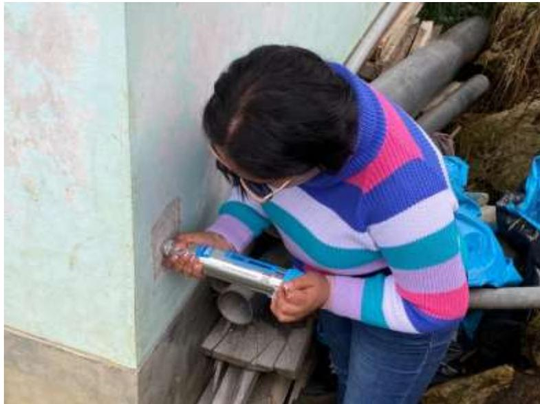
**Fotografía N°14:** Ensayo de Esclerometría para medir la resistencia.
