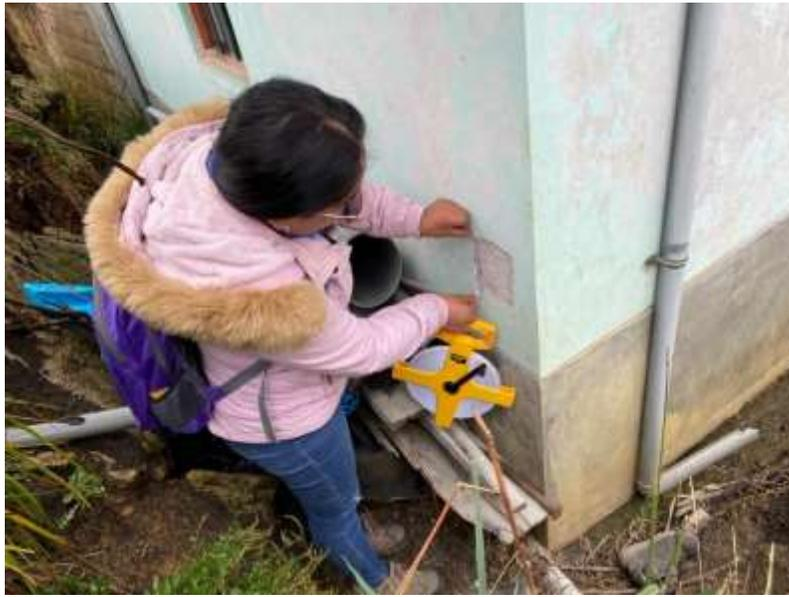
**Fotografía N°13:** Ensayo de Esclerometría para medir la resistencia.
