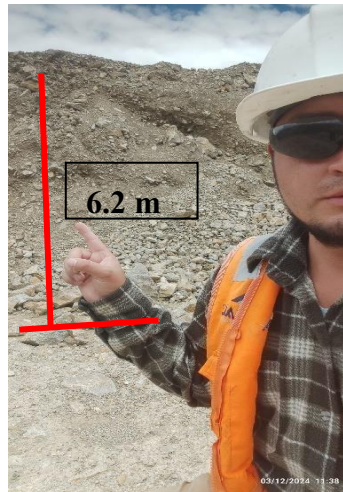
Figura 38. Espesor de cuaternario del triángulo 4. Coordenadas UTM: 819871.64 E, 9231257.21 N
