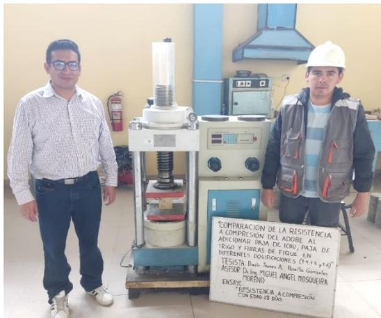
**Foto N°09:** Ensayo de resistencia a compresión de cubo de adobe.
