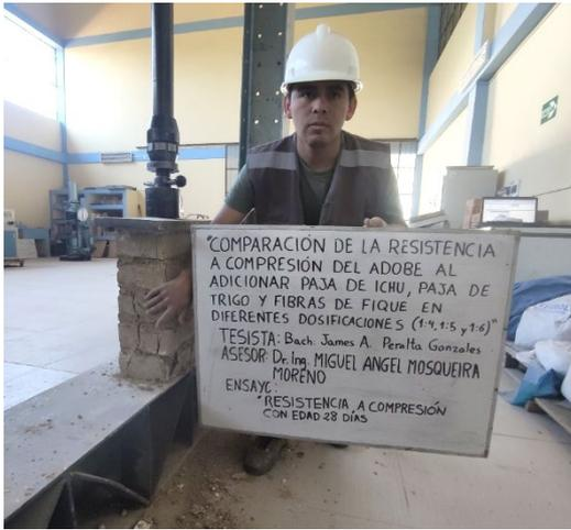
**Foto N°13:** Ensayo de resistencia a compresión en murete de adobe.
