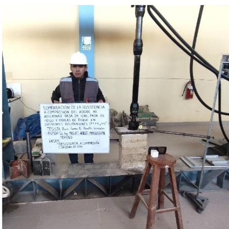
**Foto N°11:** Ensayo de resistencia a la compresión en murete de adobe.
