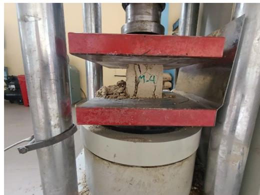
**Foto N°22:** Ensayo de resistencia a compresión en cubo de adobe – muestra patrón.
