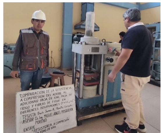
**Foto N°10:** Ensayo de resistencia a compresión de cubo de adobe.
