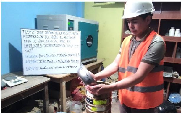
**Foto N°03:** Ensayo de granulometría.
