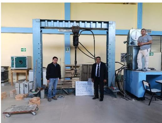
**Foto N°23:** Ensayo de resistencia a compresión en muretes de adobe – muestra patrón.
