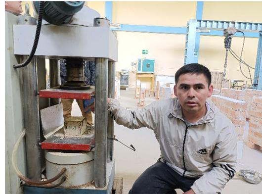
**Foto N°20:** Ensayo de resistencia a compresión en cubo de adobe – muestra patrón.
