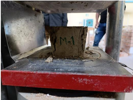
**Foto N°19:** Ensayo de resistencia a compresión en cubo de adobe – muestra patrón.
