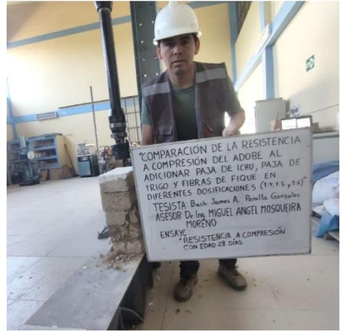
**Foto N°14:** Ensayo de resistencia a compresión en murete de adobe.
