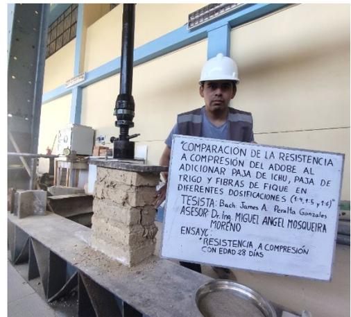
**Foto N°16:** Ensayo de resistencia a compresión en murete de adobe.
