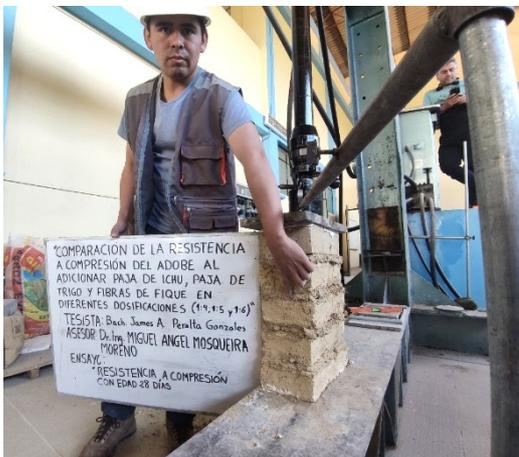
**Foto N°15:** Ensayo de resistencia a compresión en murete de adobe.
