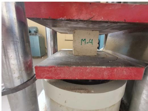
**Foto N°21:** Ensayo de resistencia a compresión en cubo de adobe – muestra patrón.
