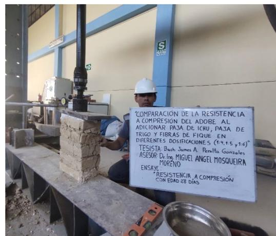
**Foto N°18:** Ensayo de resistencia a compresión en murete de adobe.
