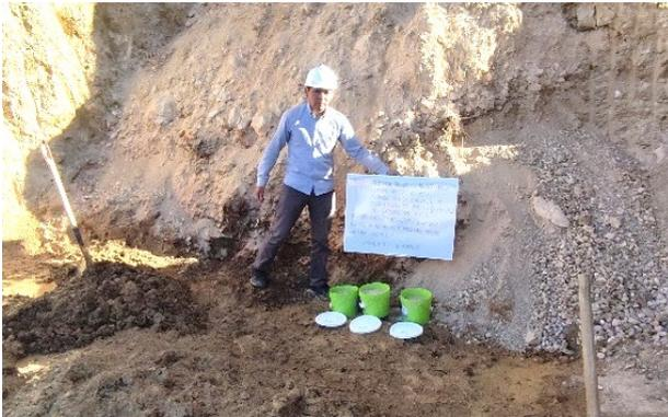
**Foto N°01:** Extracción de muestras M-1, M-2 y M-3; de la cantera Cruz Blanca.
