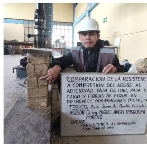
**Foto N°12:** Ensayo de resistencia a la compresión en murete de adobe.
