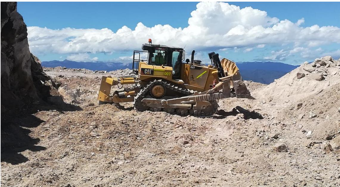
Foto 4. Corte, empuje y acumulación de puzolana con tractor.
