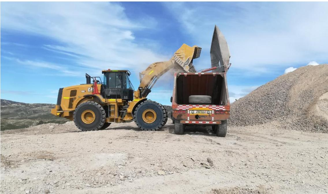
Foto 7. Carguío de material de puzolana con Cargador Cat 950H.
