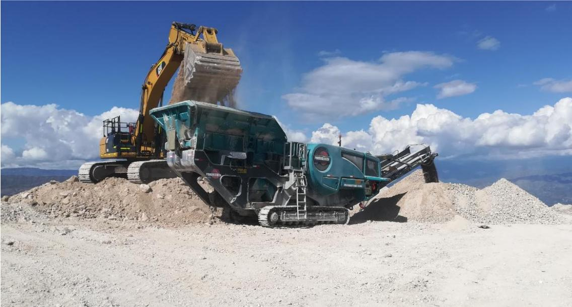
Foto 6. Chancado de material de puzolana con excavadora y chancadora.
