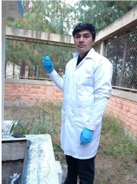
Se midió el cloro residual gracias al grifo habilitado en la tubería de entrada de la que viene de la PTAP sucre (captación La Quesera), teniendo una concentración media de 0.8 mg/l, Para obtener los valores de concentración de cloro resultante, posterior a la mezcla del agua de las 3 fuentes de suministro de agua, se midió en el segundo reservorio, a diferentes horas del día determinado así una media de 0.55 mg/l.
