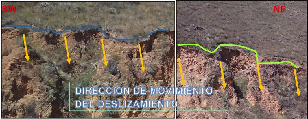
Foto 12: Deslizamientos menores combinados con poco aporte de detritos.
