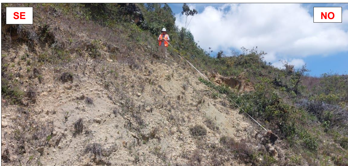
Fotografía 2 Medición del área de influencia de un Movimiento de Masa, se presenta rasgos de arrastre de material, con pendientes pronunciadas.
