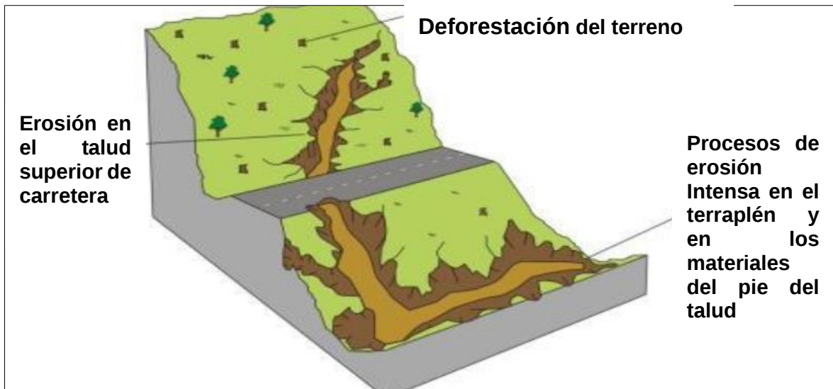
Figura 11 Esquema de erosión de laderas
