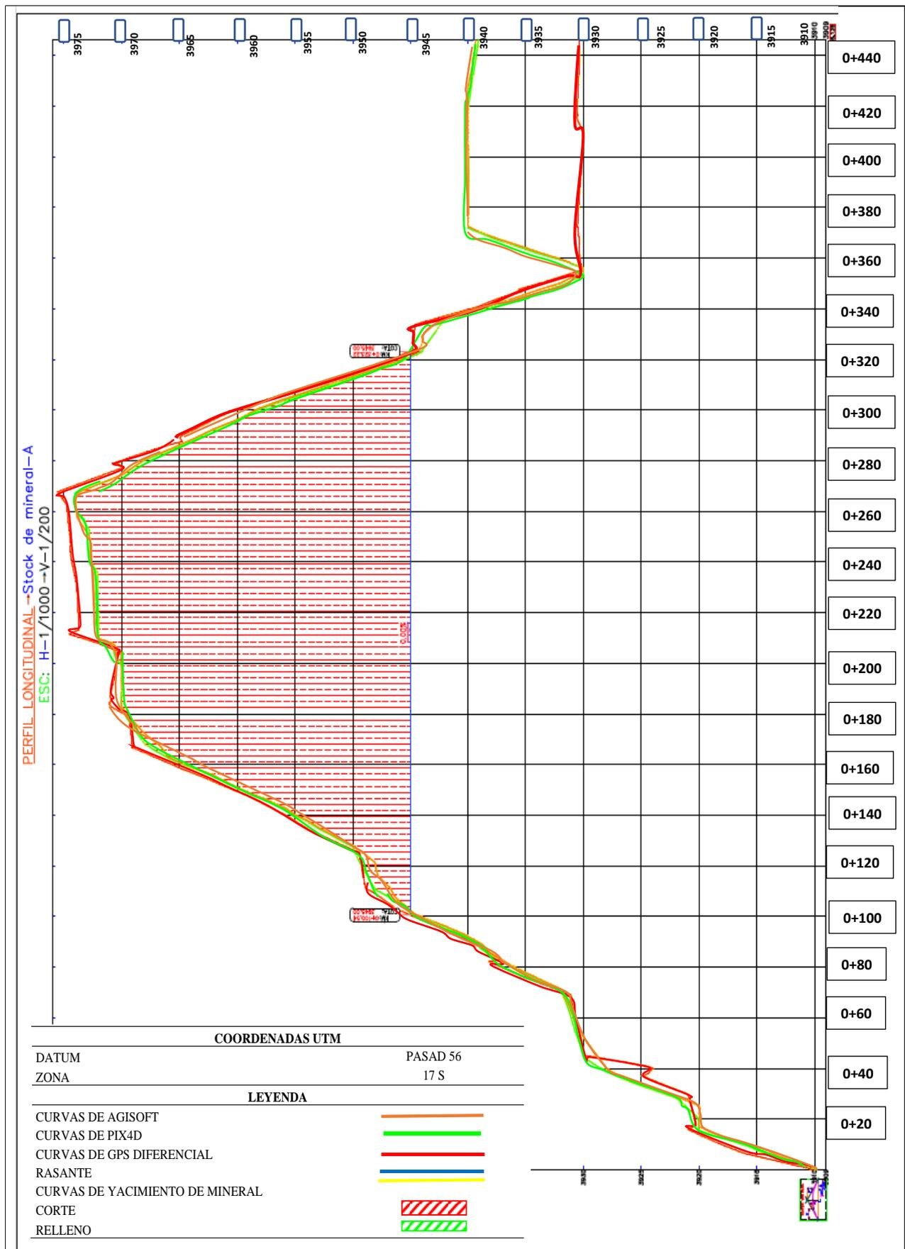
Figura 58 Altimetría de Yacimiento mineral - GPS Diferencial y Agisoft -V 5m.
