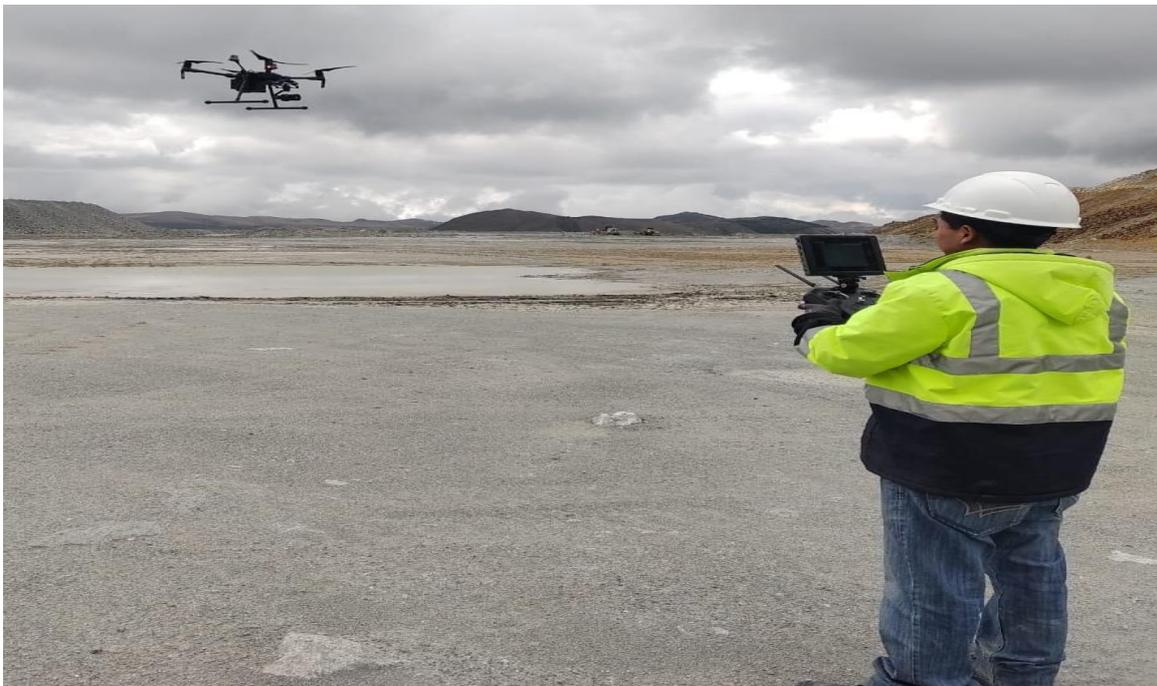
Figura 27 Levantamiento fotogramétrico con dron (RPAS).
