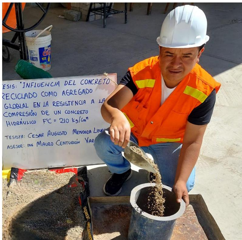
**Figura 17: Ensayo del peso unitario suelto del agregado grueso reciclado.**
