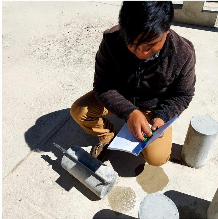
**Figura 26: Peso unitario del concreto endurecido.**
