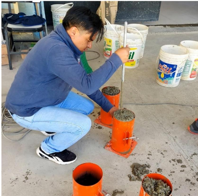
**Figura 23: Determinación del peso unitario del concreto fresco.**
