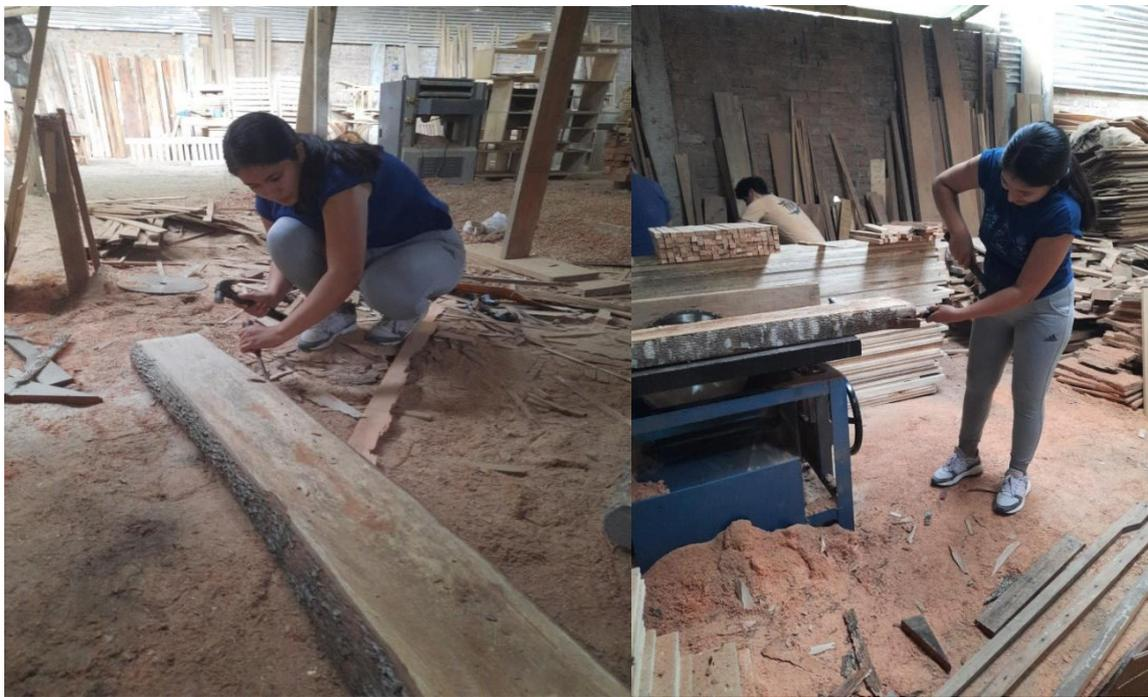
Foto 7 y 8. Habilitado de vigas en aserradero para obtención de probetas.
