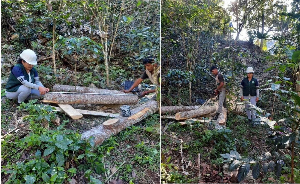
Fotos 5 y 6. Habilitado de cuarterones o vigas para traslado a laboratorio
