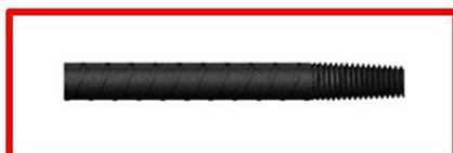
Se reduce la sección de la barra y la falla tiende a producirse en la conexión.
