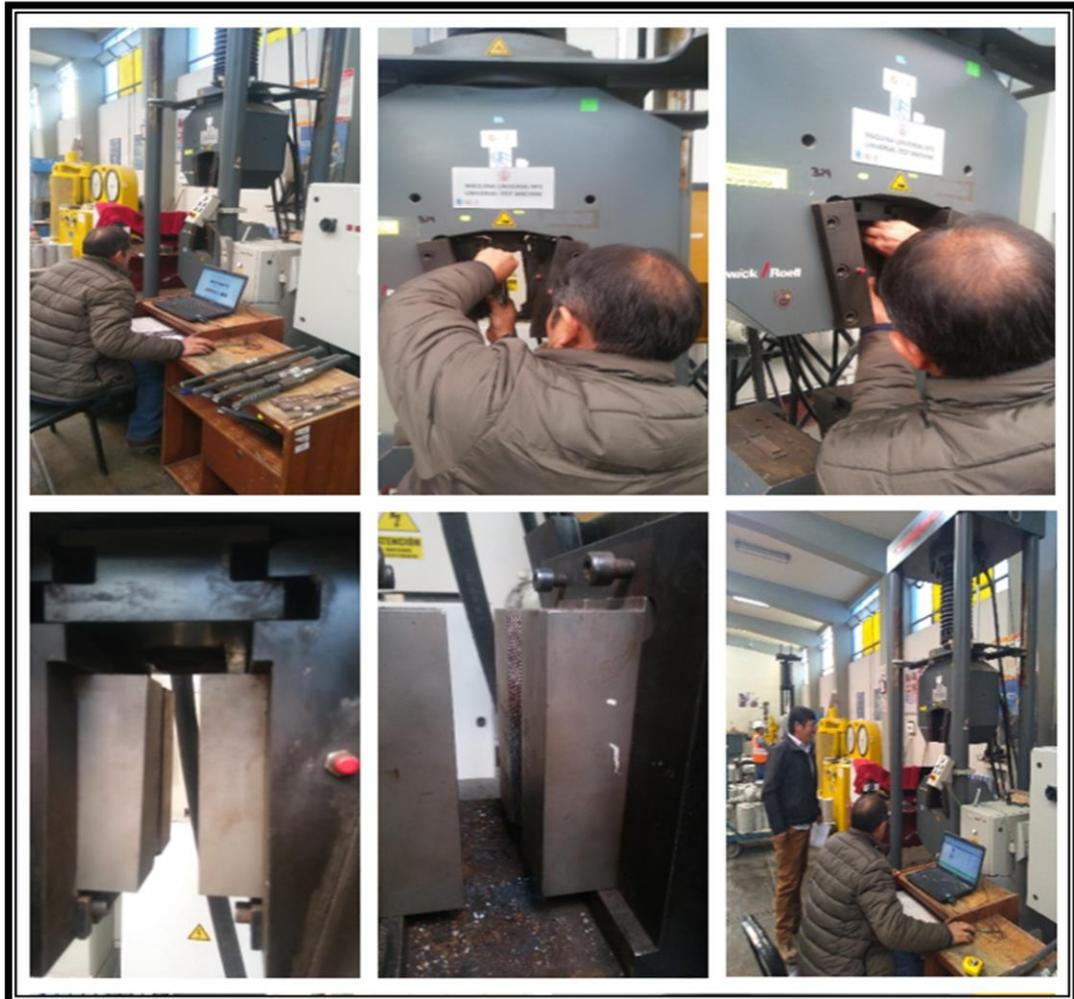
Como parte de las actividades de control y aseguramiento de calidad de los ensayos de tracción; en las actividades previas a la realización de estos ensayos se revisó y verificó los certificados de calibración de cada uno de los equipos de medición y ensayo; donde se pudo apreciar su vigencia, código, marca, número de serie, etc.; a fin de asegurar y garantizar la calidad y confiabilidad de los datos al realizar cada uno de los ensayos de tracción.
