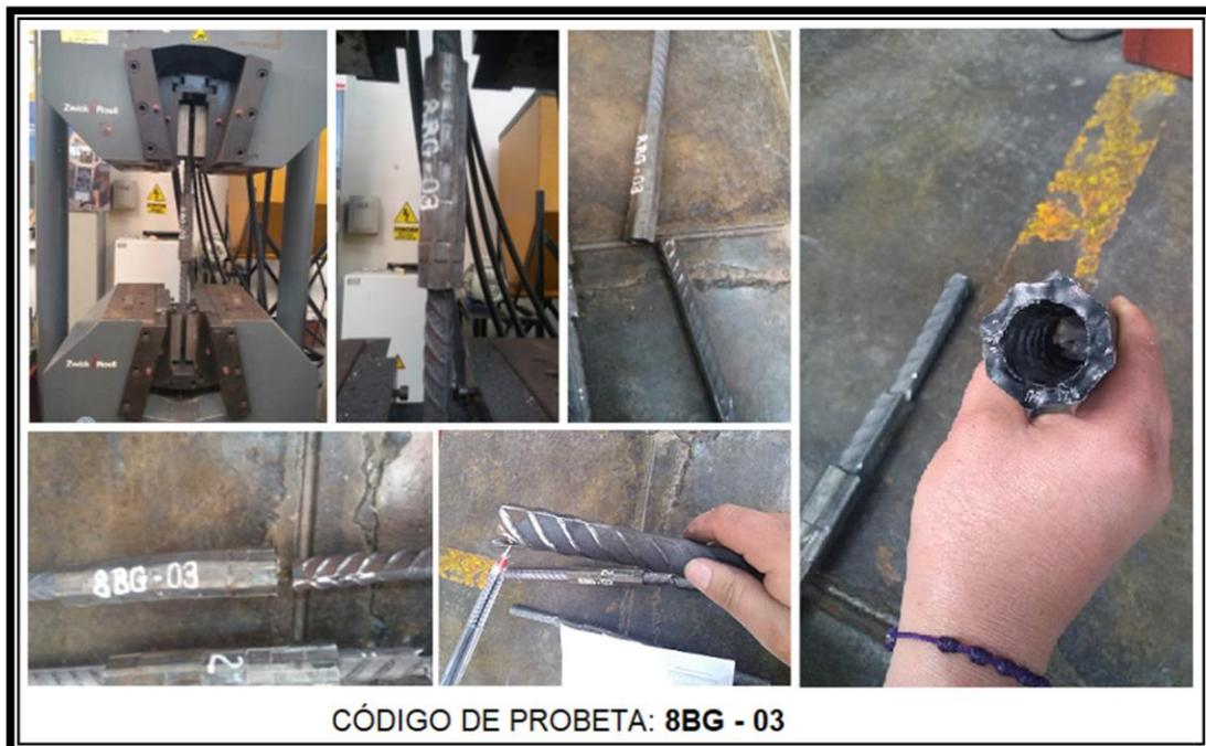
Al realizar el ensayo de tracción, en esta probeta de código 8BG – 03, se produjo el desacoplamiento de la barra desde el interior del conector mecánico de presión BARGRIP XL, es decir, se desacopló la barra de acero corrugado inferior de diámetro 1” que conformaba esta probeta.
