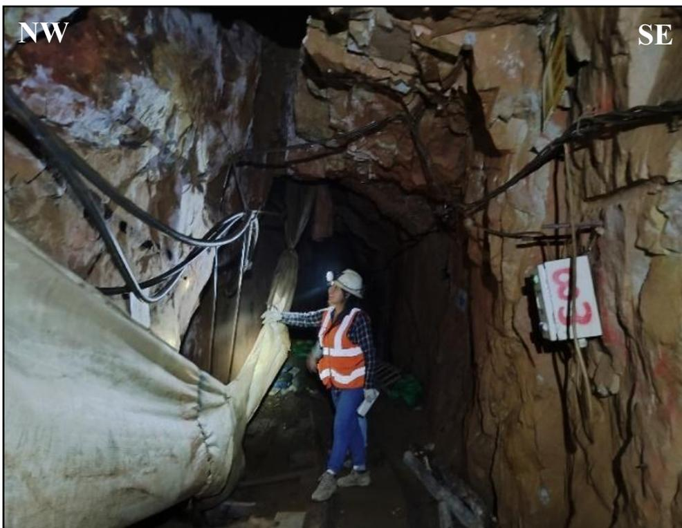
Foto 27. Mangas de ventilación sin estar enganchadas en alcayatas, provocando deficiencias del flujo de aire hacia las zonas de trabajo.
