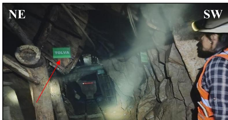
Foto 4. Chimenea de tolva y echadero por donde baja el mineral de las galerías y cruceros principales a las vagonetas U35.
