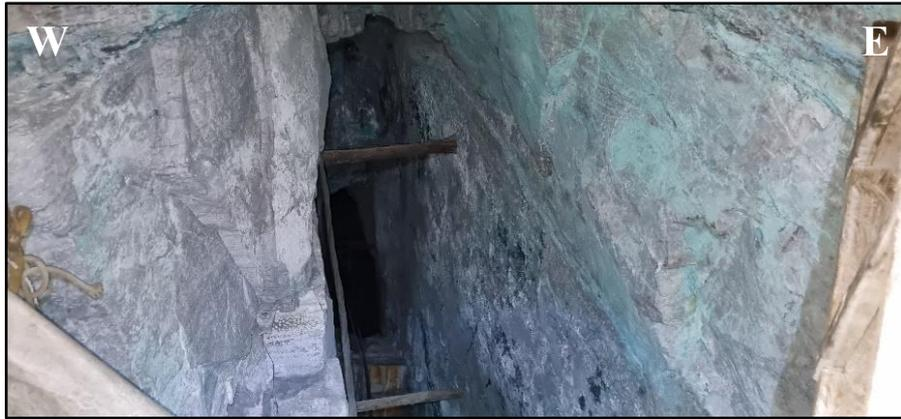
Foto 5. Chimenea de acceso para el transporte de personal y servicios de agua, aire, energía y ventilación. Se conecta entre varios niveles.
