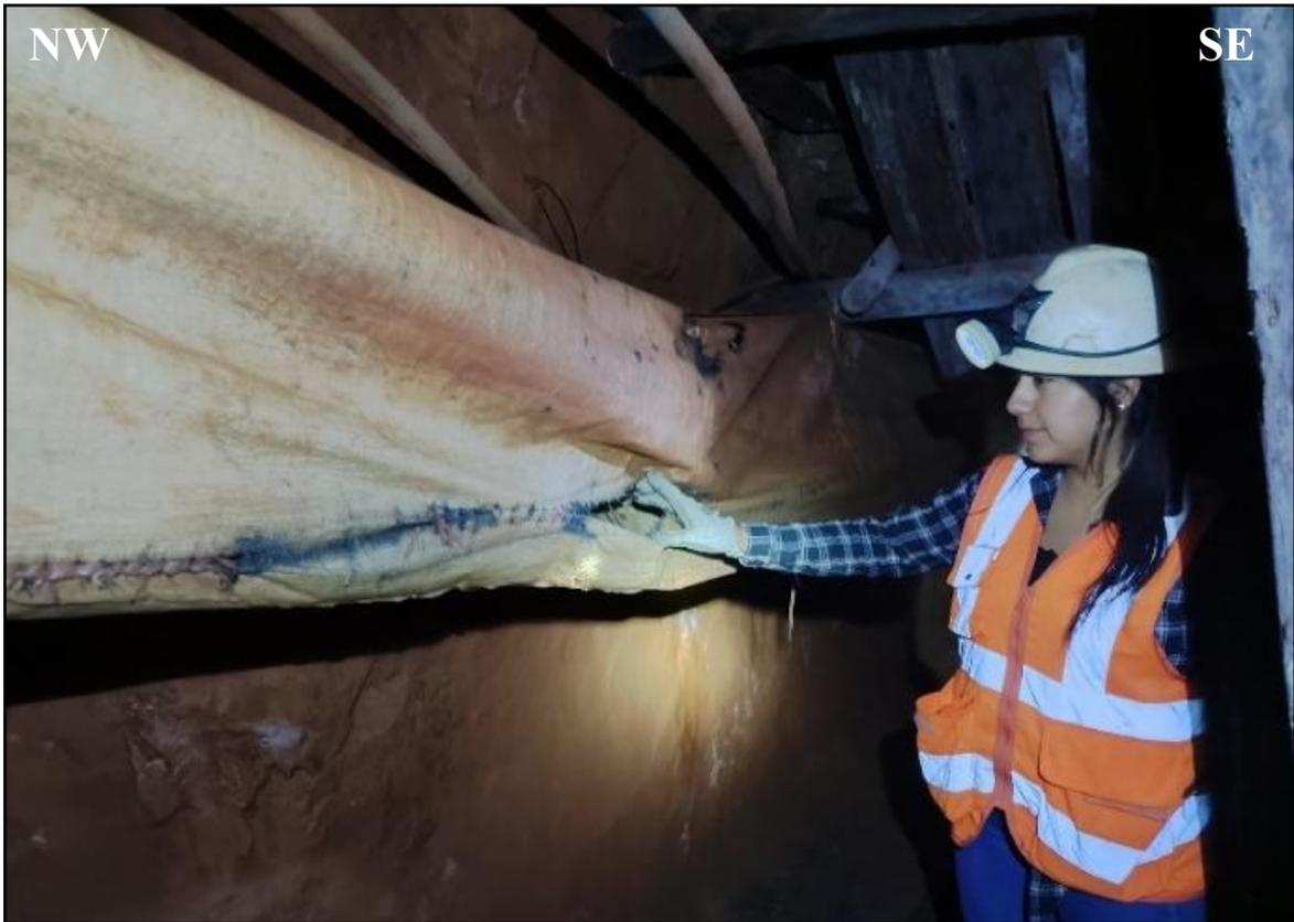
Foto 28. Mangas de ventilación en mal estado presentan roturas mostrando falta de mantenimiento.
