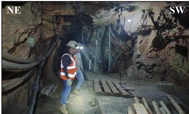
Foto 3. Pique de Izaje de minerales polimetálicos Cu y Au, mediante unas chanchas de jebe con cable acerado, polea y winche de Izaje
