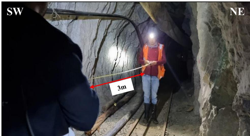
Foto 14. Método experimental: Con una wincha se midió 3 metros de distancia entre dos personas. Nv. 2880 estación de monitoreo EV-03.
