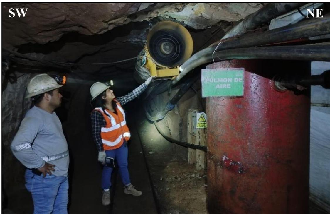
Foto 25. Ventilador tipo Impelente enganchado en la parte superior con pernos de anclaje y cable acerado a presión.
