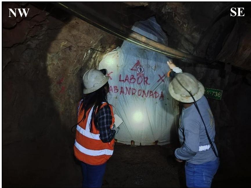
Foto 6. Labores abandonadas cubiertas para restringir el acceso del personal en obra.
