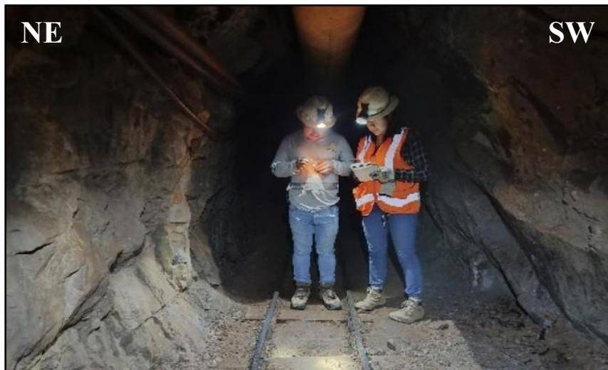
Foto 18. Método experimental: Se enciende la bengala y se controla el tiempo que tarda en llegar el humo al otro punto en una distancia de 3 metros. Nv. 3060 EV-07.
