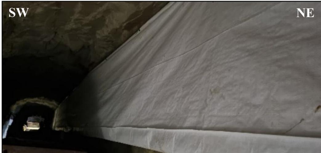
Foto 10. Mangas de Nylon blanco de 18'' de ancho ubicadas al costado de la parte superior, son colgadas por alcatayas para inyectar aire limpio a las labores de trabajo.
