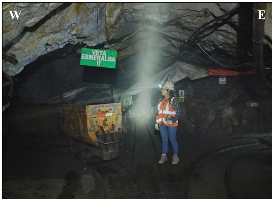
Foto 23. Veta Esmeralda II ubicada en la zona Sur, con dirección W – E, cota 3000 m.s.n.m y 72° de buzamiento; cuenta con 3 frentes de trabajo.
