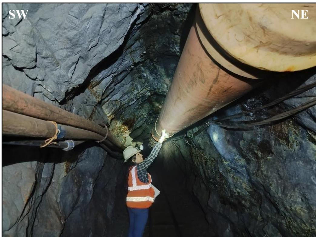
Foto 11. Mangas de tubería PVC de 18'' ubicadas en la parte superior con pernos de anclaje y cable acerado a presión para inyectar aire limpio a las labores de trabajo.
