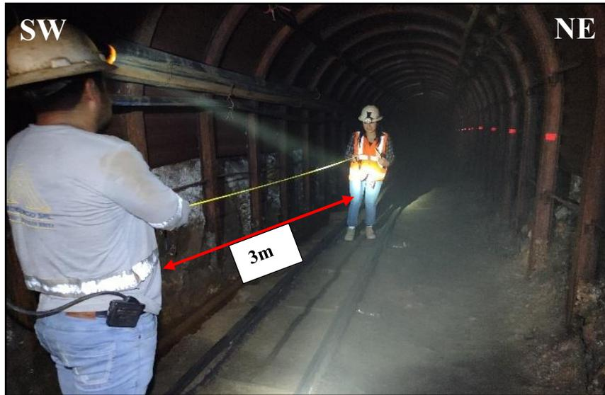
Foto 17. Método experimental: Con una wincha se midió 3 metros de distancia entre dos personas. Nv. 3060 estación de monitoreo EV-01.
