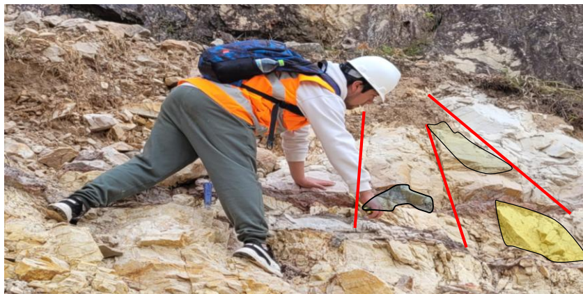
Foto 7. Caracterización de las discontinuidades de la Estación Geomecánica 02.
