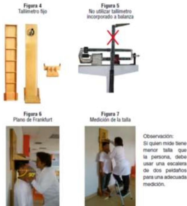
**Revisión del equipo:** el deslizamiento del tope móvil debe ser suave y sin vaivenes, la cinta métrica debe estar adherida al tablero y se debe observar nítidamente su numeración. Asimismo, se debe verificar las condiciones de estabilidad del tallímetro.
