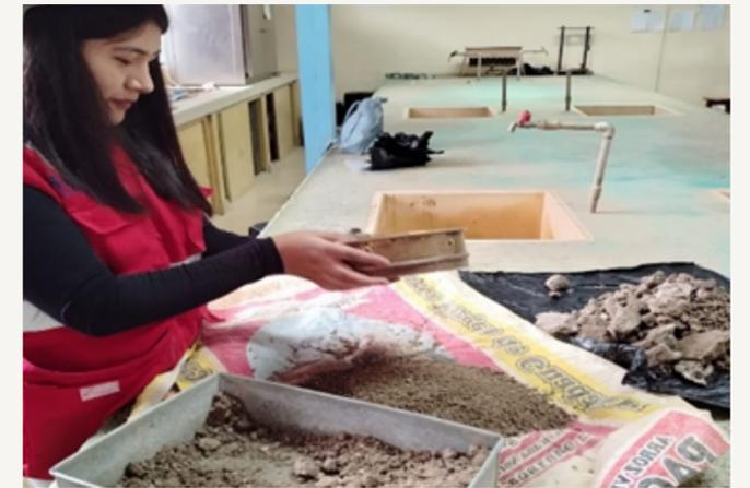
Ensayo granulométrico de suelos a través del tamiz N°4, para la separación de grava y arena.
