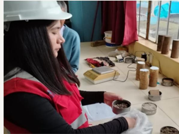
Preparación de las muestras para determinar el contenido de humedad.
