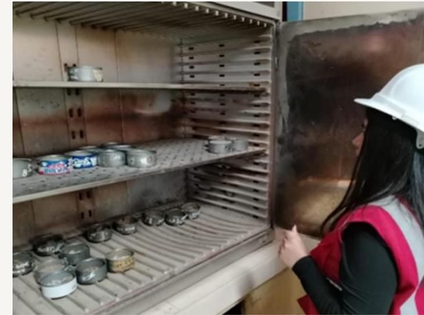
Secado de muestras al horno a una temperatura de 110° C, para determinar contenido de humedad y límites de consistencia.
