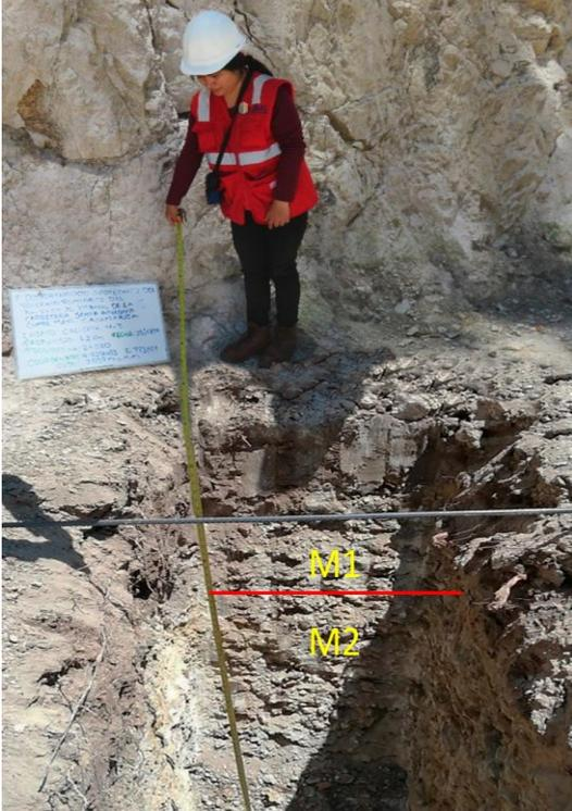
Figura 16.Registro de Excavación de la Calicata N°1 (PC-01) en la progresiva Km 2+000.
