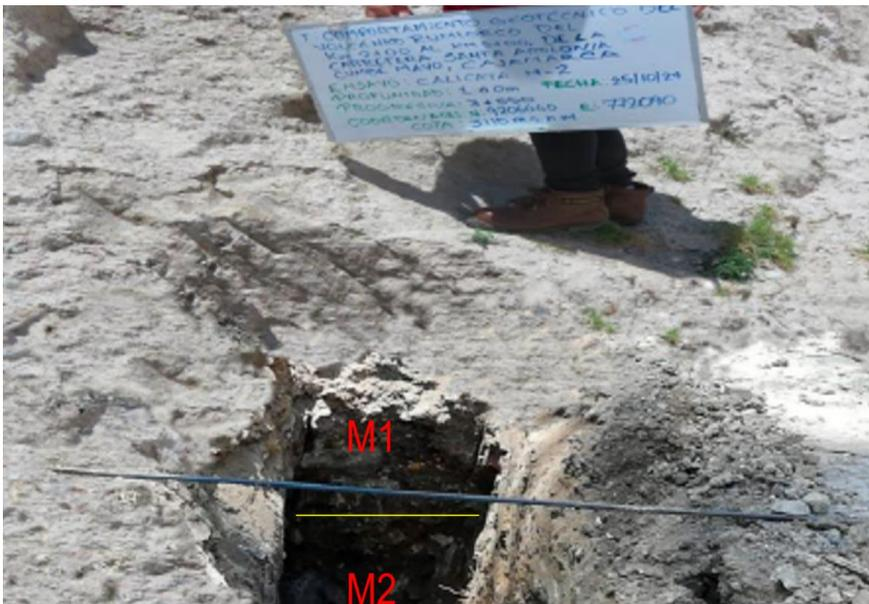
Figura 38. Registro de Excavación de la Calicata N°2 (PC-03) en la progresiva Km 3+550.
