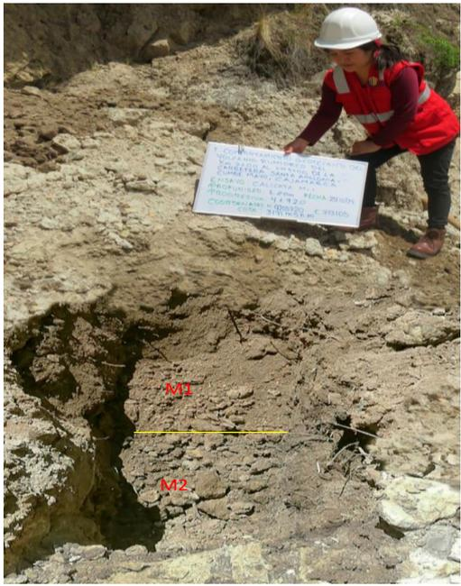
Figura 59. Registro de Excavación de la Calicata N°3 (PC-05) en la progresiva Km 4+920.
