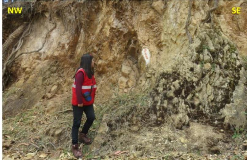
Foto 3. Calizas intercaladas con arcillolitas de la Formación Chúlec al Nor Oeste de la zona de estudio, en la progresiva km 3+020
