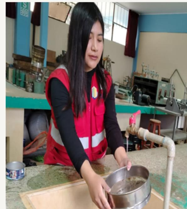
Ensayo granulométrico de finos concerniente al Tamiz N°4 por el método del lavado.
