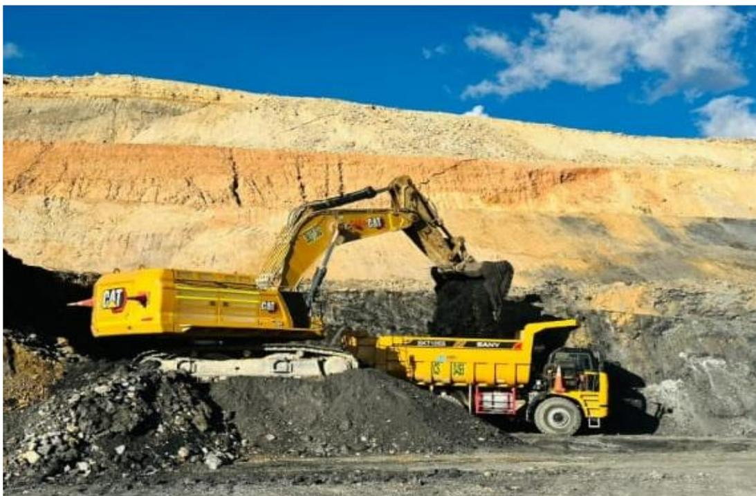
Figura 9:Equipo de carguío y acarreo (Unidad Minera el Toro,2022)
