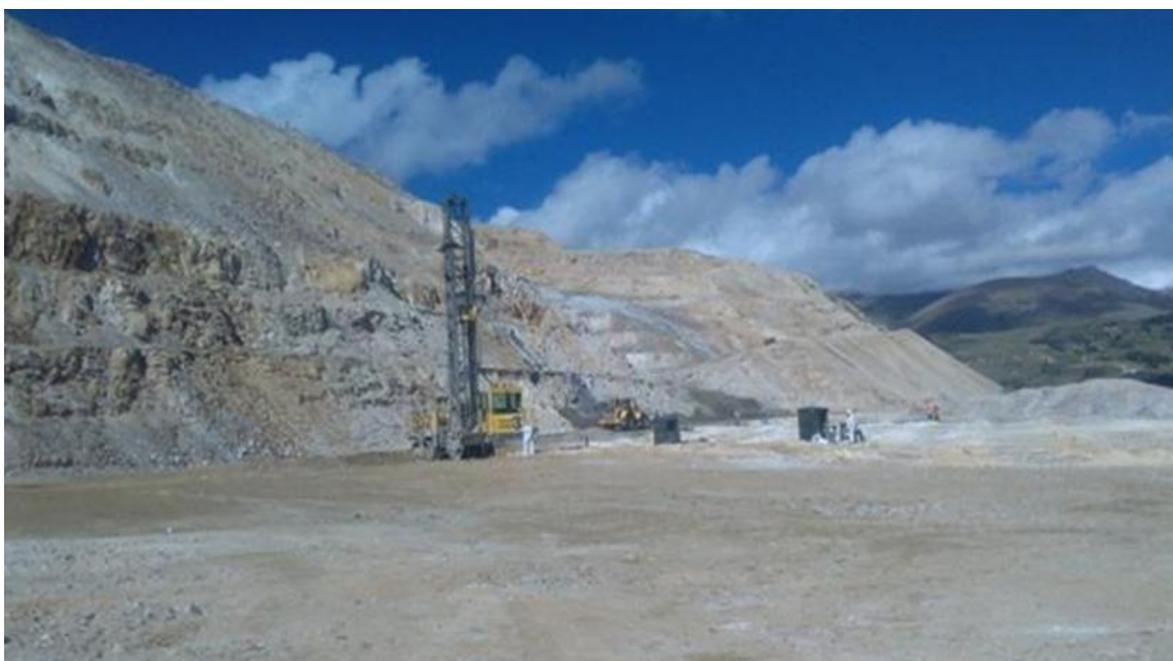
Figura 17: Perforadora DME45, perforación en banco (Mina el toro,2022)
