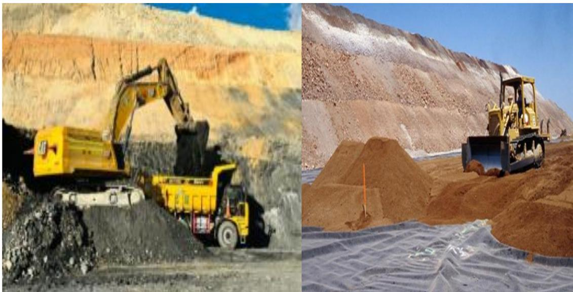
Figura 3: Carguío, carreo y formación de pilas de lixiviación.
