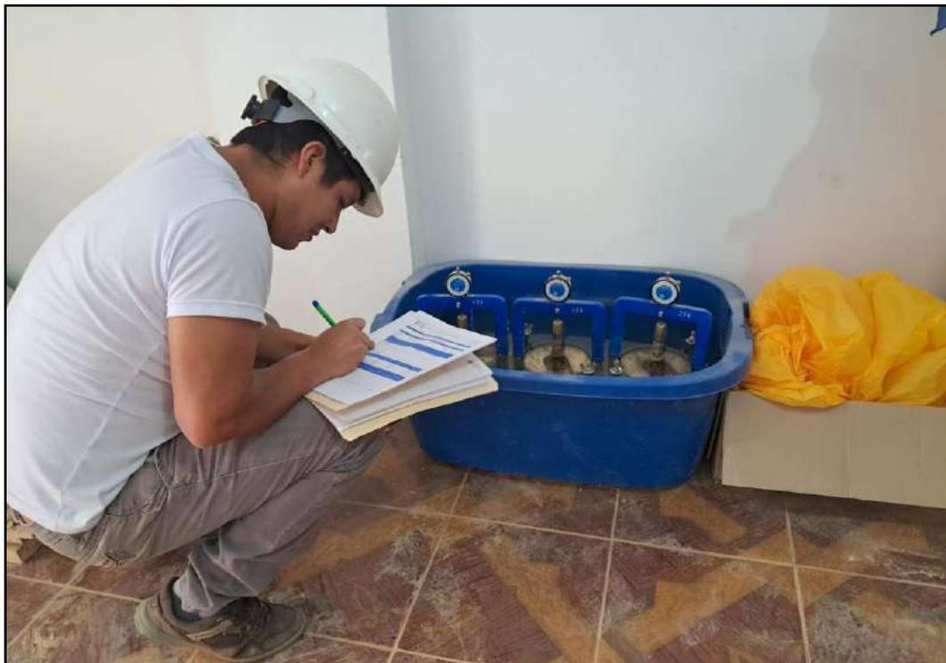
Figura 26: Ensayo de CBR, en el equipo de CBR. Muestra de suelo A2 Y A6
