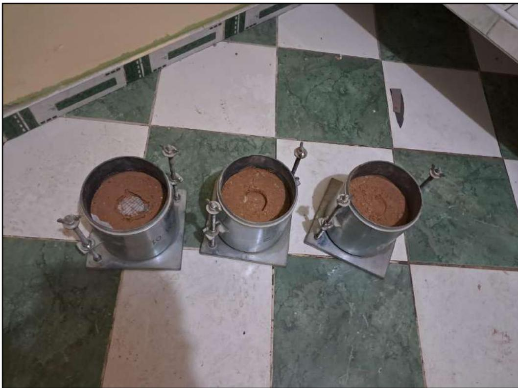
Figura 28: Ensayo de CBR de muestras de suelo A-6 con aditivo
