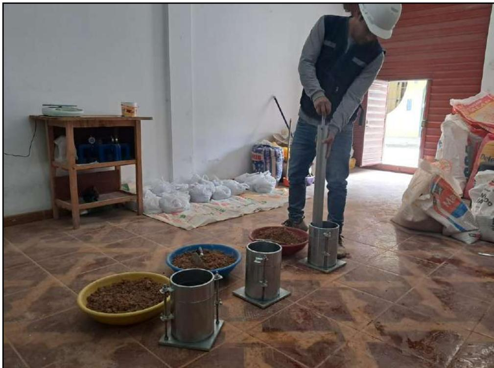
Figura 22: Control la expansión de Los suelos al saturarse
