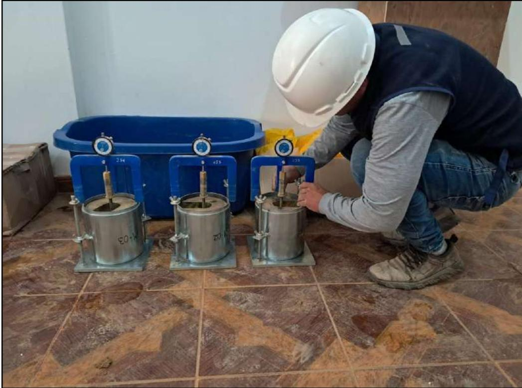
Figura 23: Molde de CBR para saturar por 4 días y verificar su expansión
