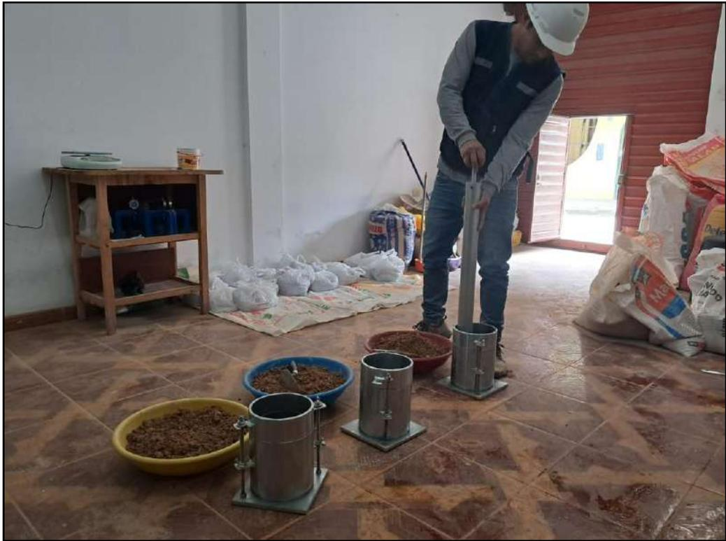
*Figura 21: Enrase de espécimen para densidad compactada de la muestra*
