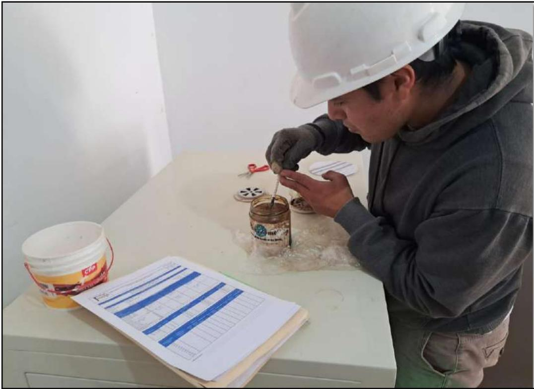
Figura 19: Preparación de Material para ensayo de CBR Con aditivo
