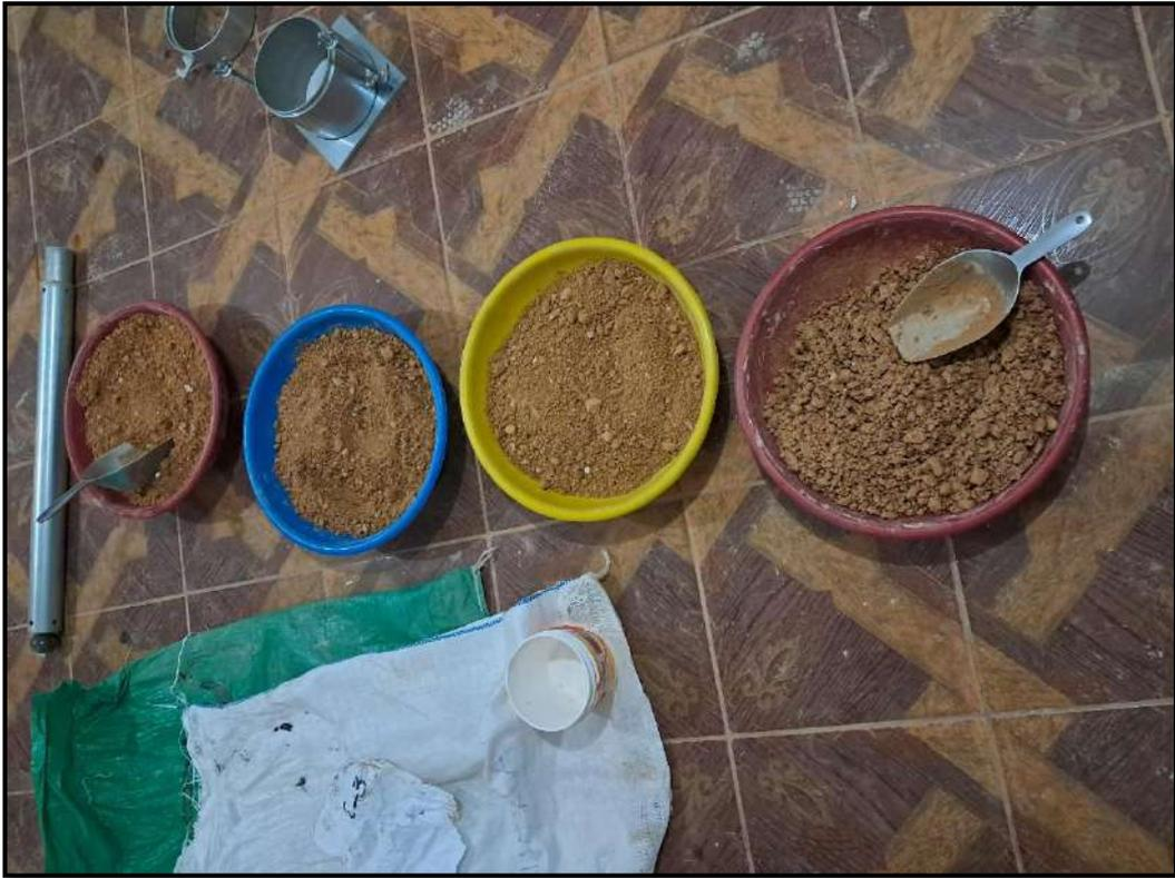
Figura 17: Preparación de muestras para ensayo de CBR sin aditivo.
