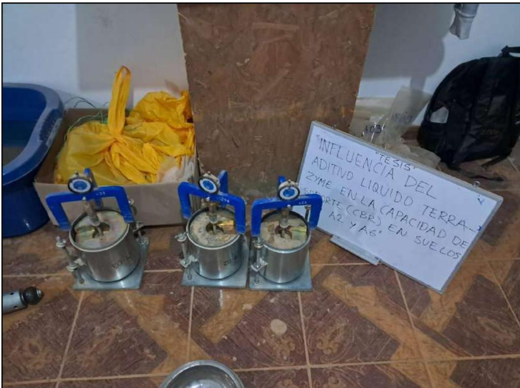
Figura 24: Saturación de especímenes de muestras.
