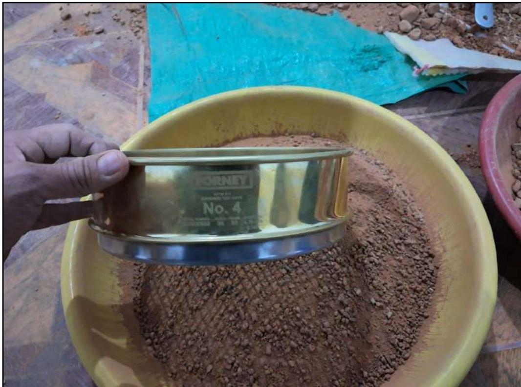
Figura 16: Preparación de Muestra sin Aditivo para ensayos Proctor Modificado
