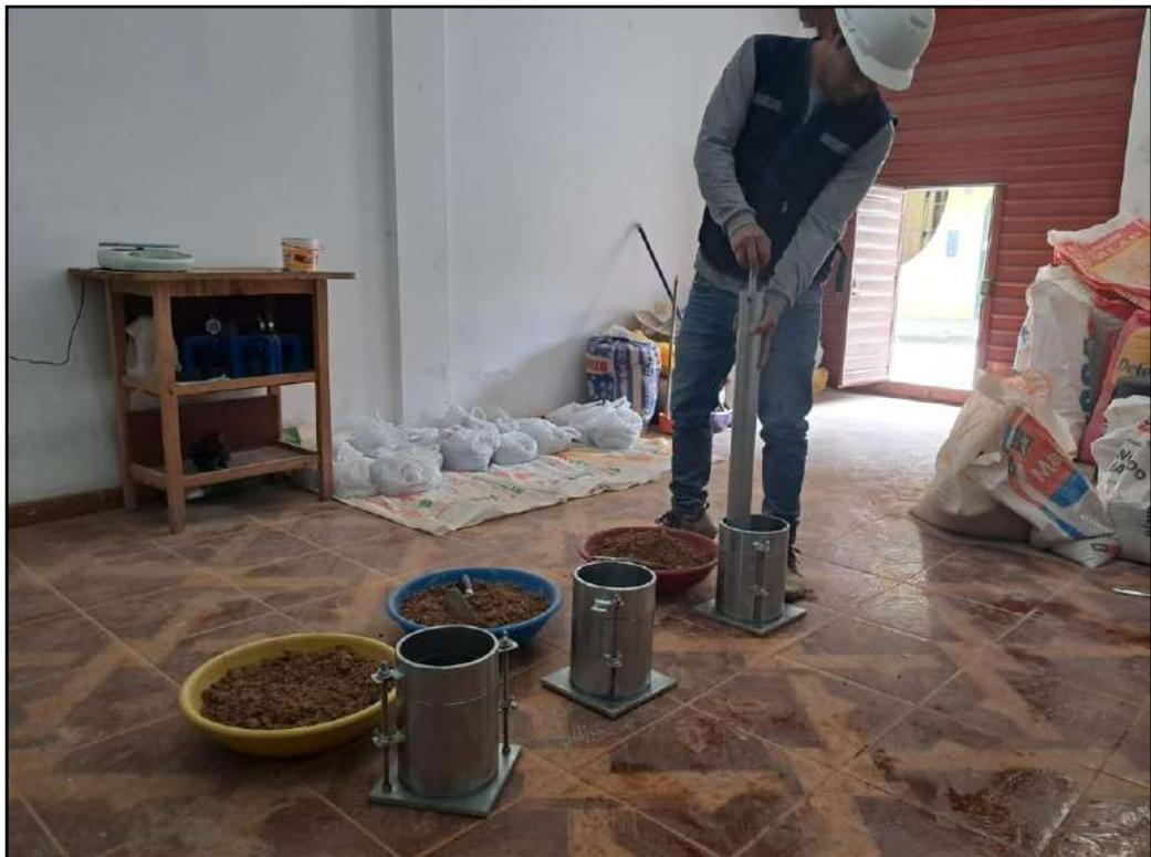
Figura 18: Dosificación de Aditivo Terrazyme, para CBR de suelo A2
