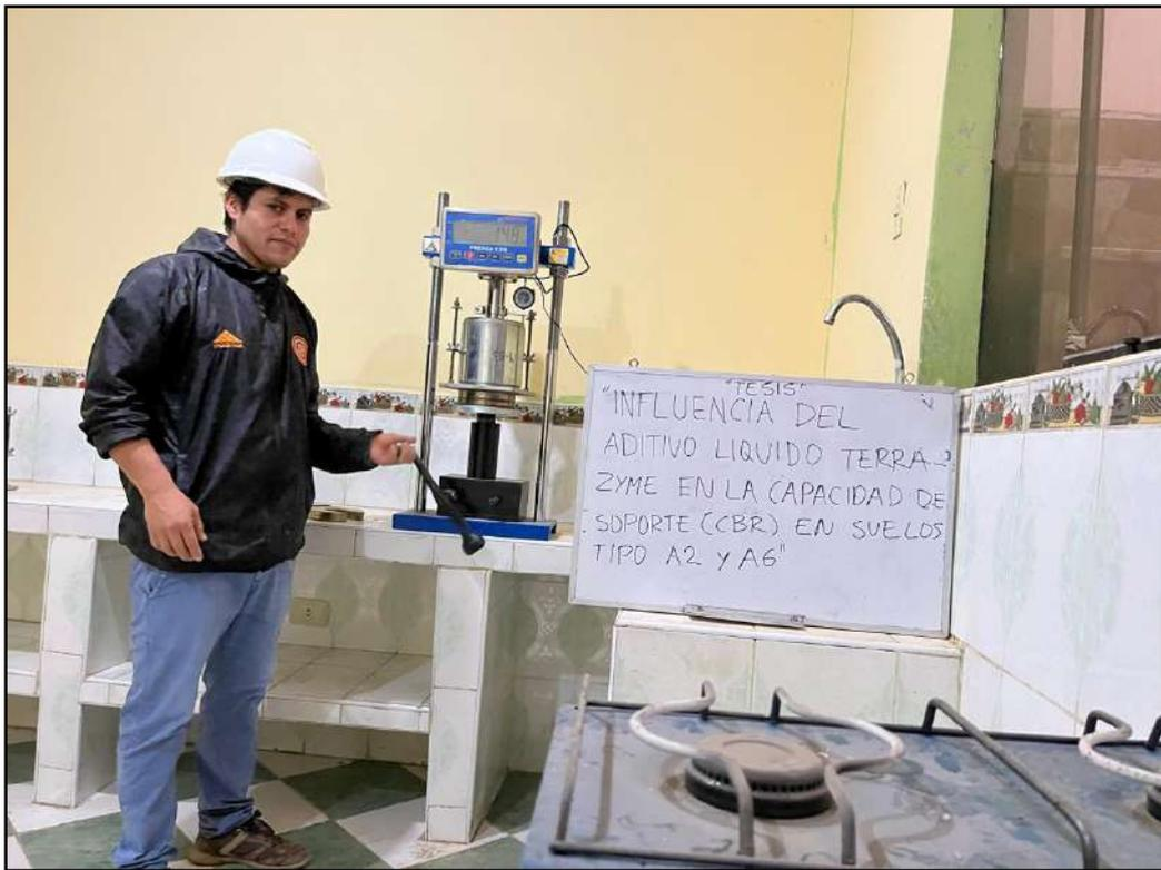
Figura 27: Ensayo de CBR de muestras de suelo A-2 con aditivo
