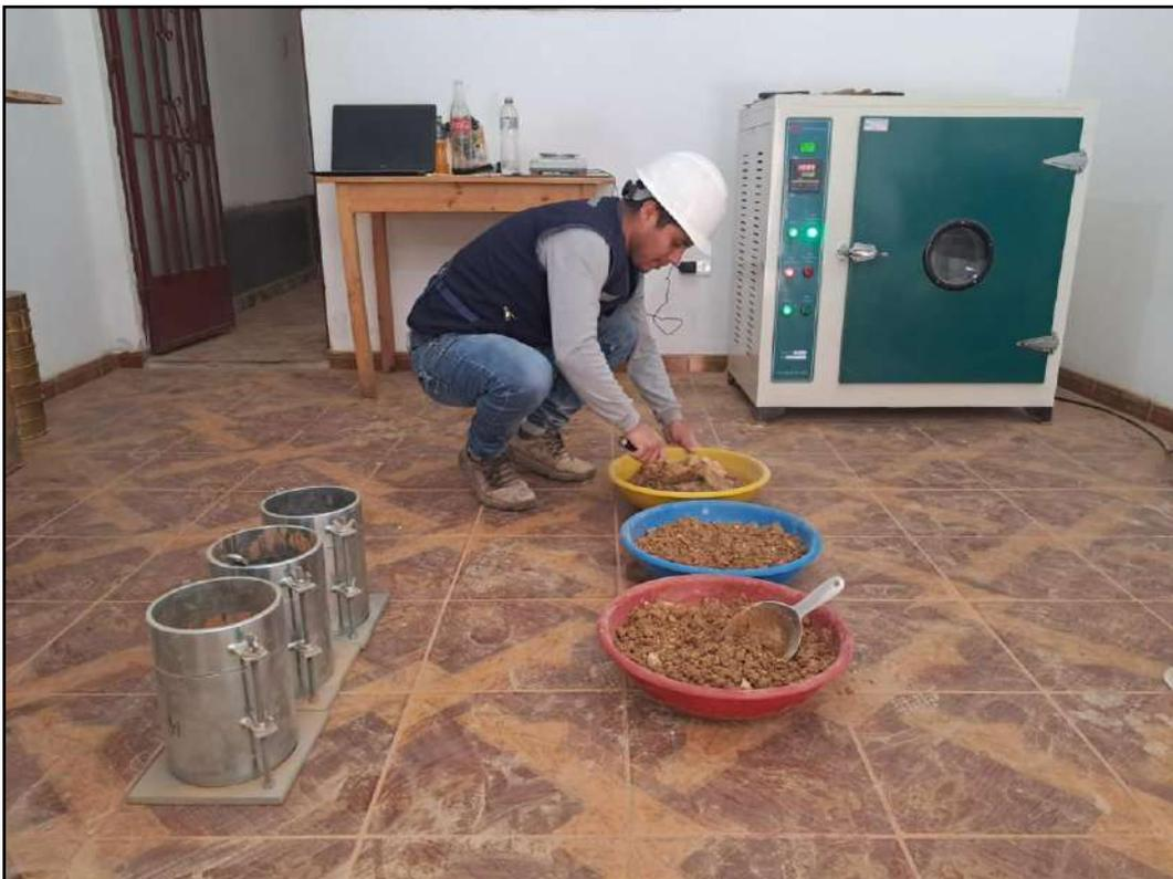
*Figura 20: Compactación Para ensayo CBR de suelo tipo A-2*
