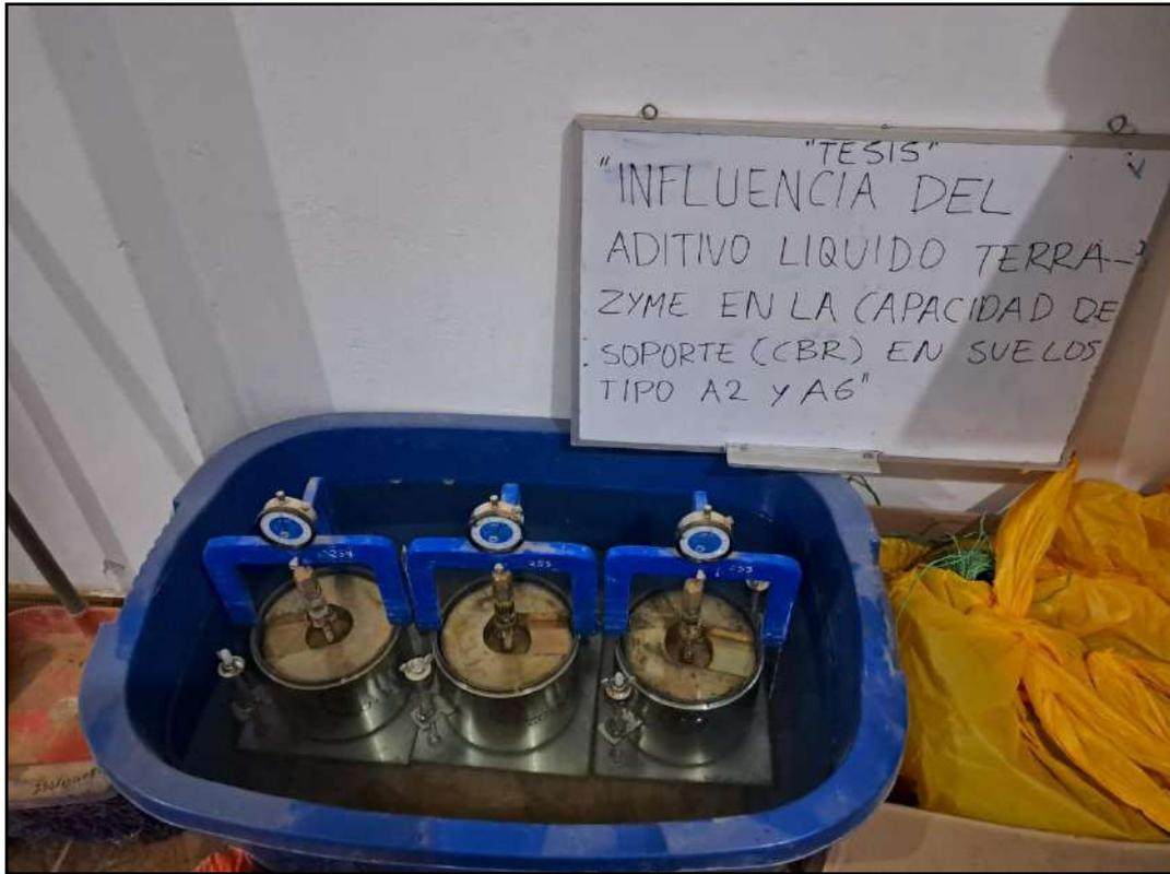
Figura 25: Toma de datos de expansión de Suelo saturado cada 24 horas
