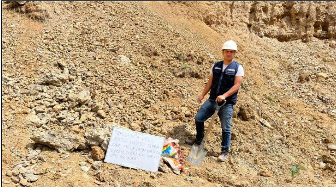
*Figura 11: Toma de muestra de Canteras suelo tipo A2, suelos gruesos*
