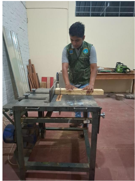
Fotos 5 y 6. Elaboración de probetas en laboratorio para propiedades físicas y mecánicas
