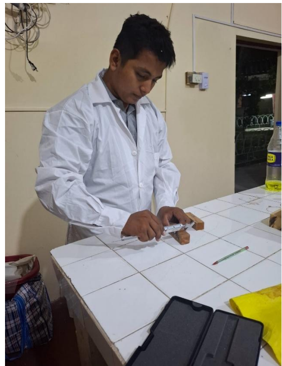
Fotos 7 y 8. Aclimatación y medición de probetas de propiedades físicas
