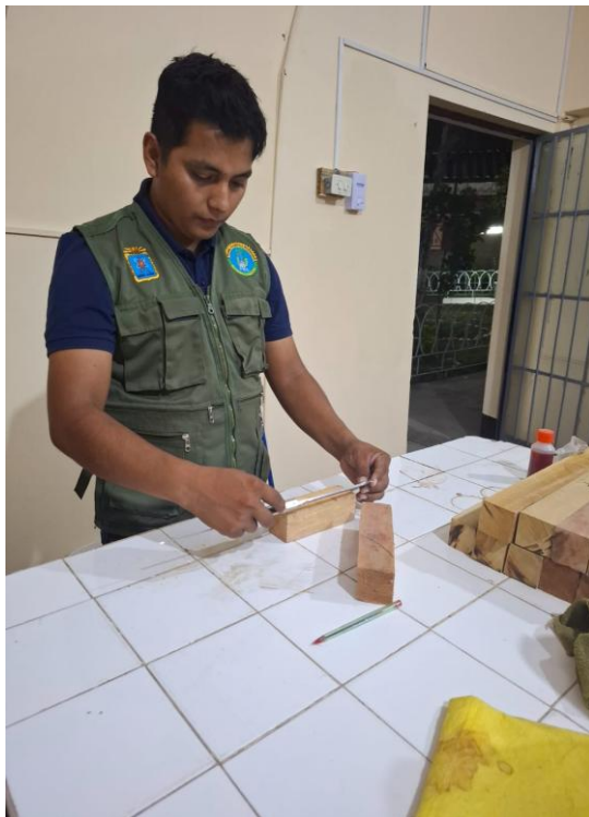
Fotos 15 y 16. Medición y pesado de contenido de humedad de ensayo de probetas de propiedades mecánicas
