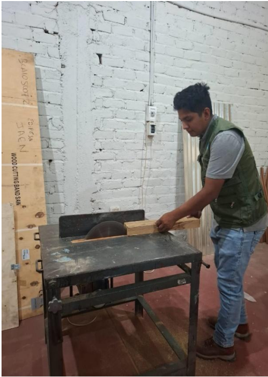
Fotos 5 y 6. Elaboración de probetas en laboratorio para propiedades físicas y mecánicas
