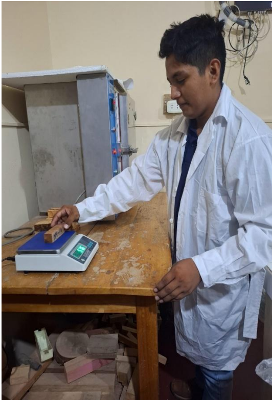
Fotos 9 y 10. Pesado y secado de las probetas de propiedades físicas
