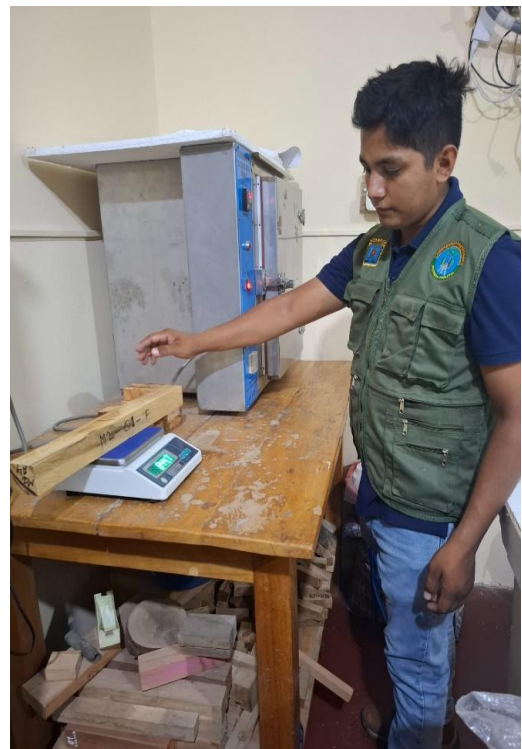
Fotos 15 y 16. Medición y pesado de contenido de humedad de ensayo de probetas de propiedades mecánicas
