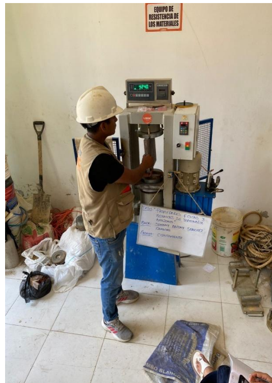
Fotos 11 y 12. Ensayo de propiedades mecánicas de laboratorio
