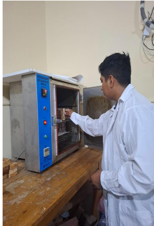
Fotos 9 y 10. Pesado y secado de las probetas de propiedades físicas
