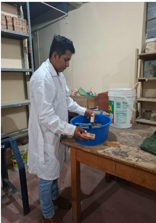
Fotos 7 y 8. Aclimatación y medición de probetas de propiedades físicas
