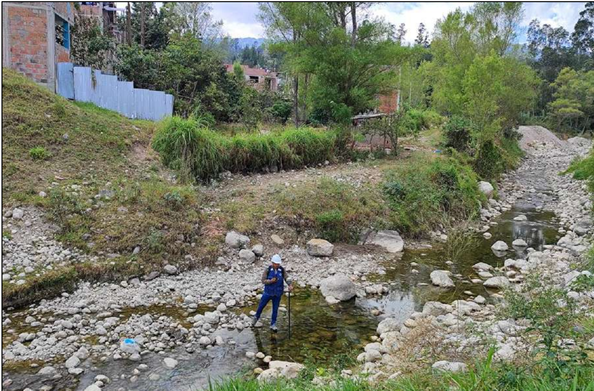
Fotografía 21. Levantamiento con GPS diferencial del tramo de estudio.
