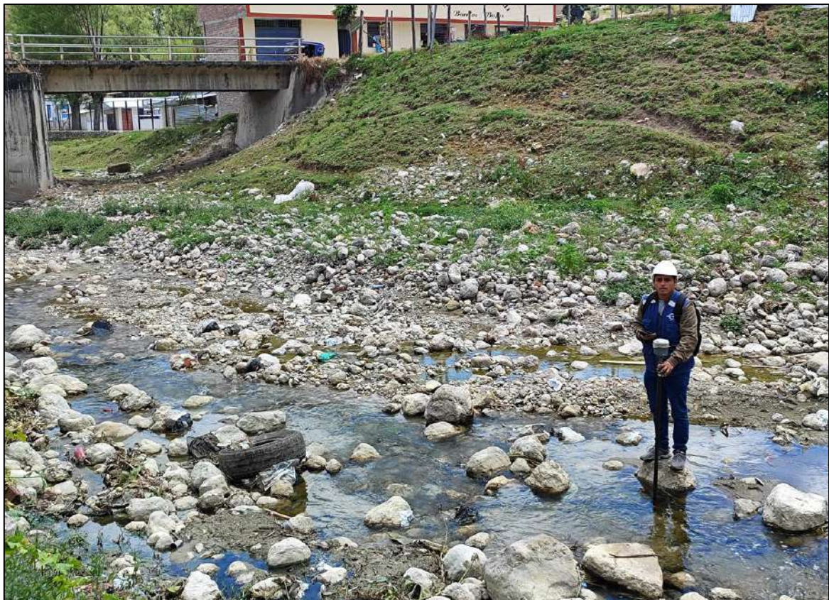
Fotografía 19. Levantamiento con GPS diferencial del tramo de estudio.
