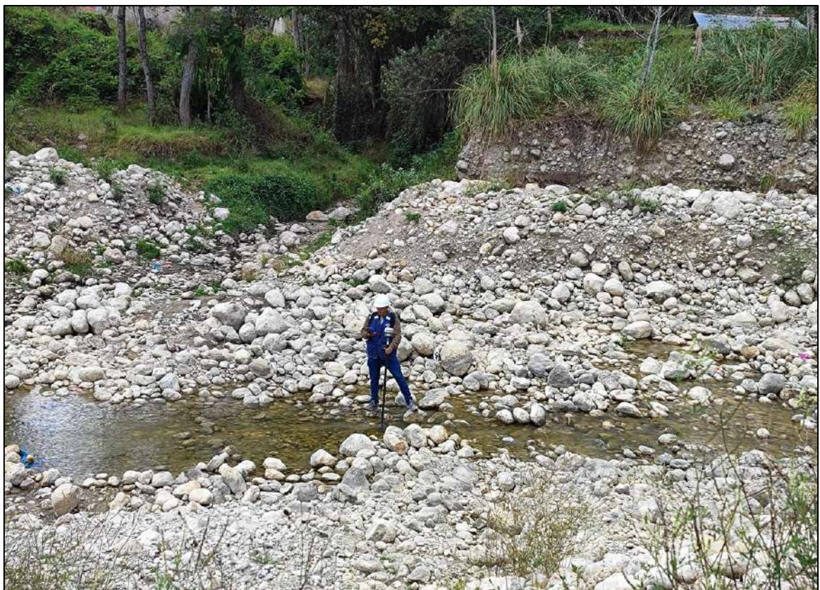
Fotografía 21. Levantamiento con GPS diferencial del tramo de estudio.
