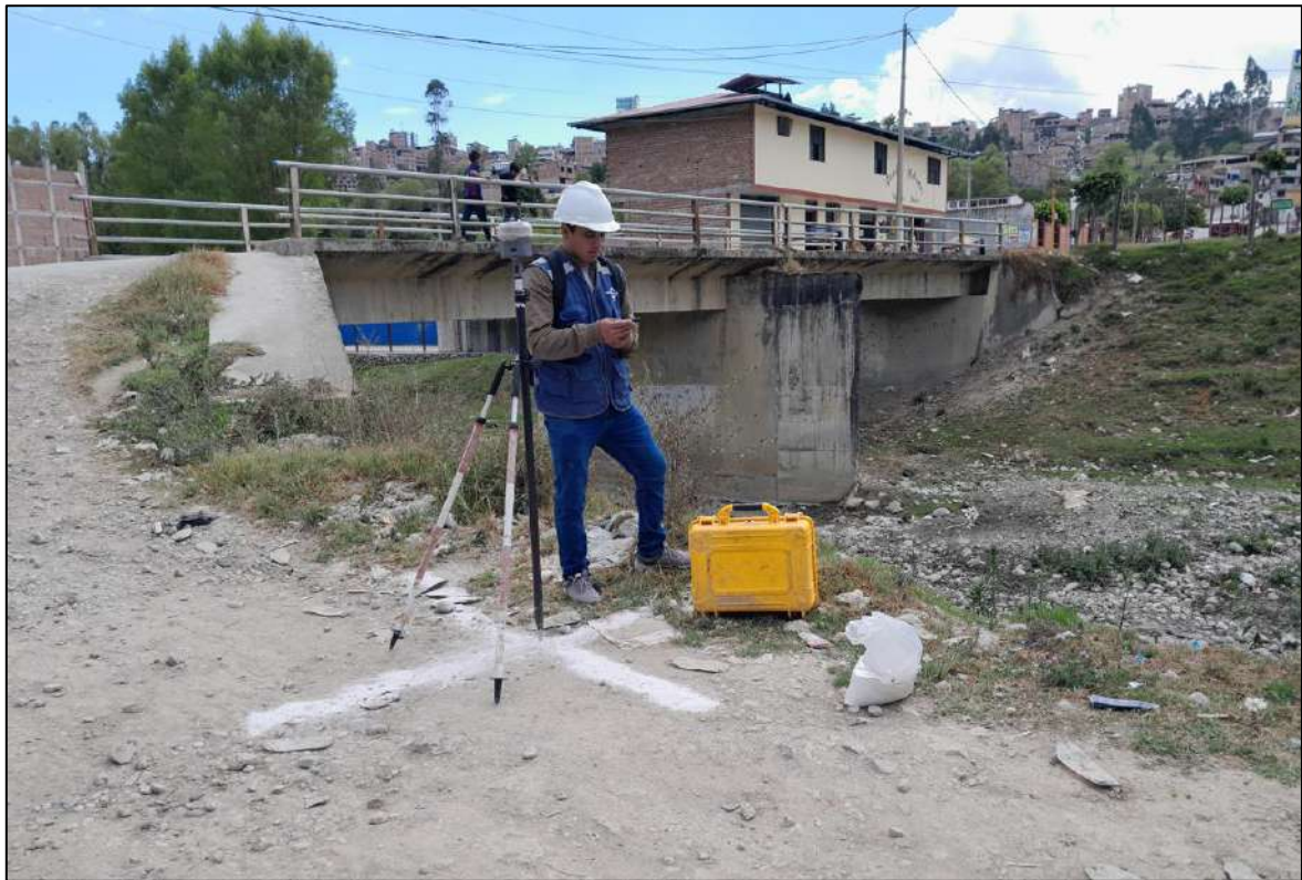
Fotografía 19. Levantamiento con GPS diferencial del tramo de estudio.
