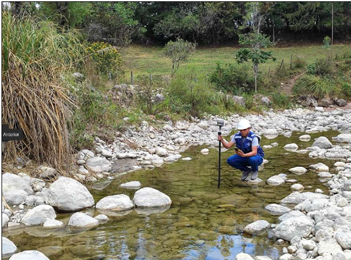
Fotografía 23. Levantamiento con GPS diferencial del tramo de estudio.
