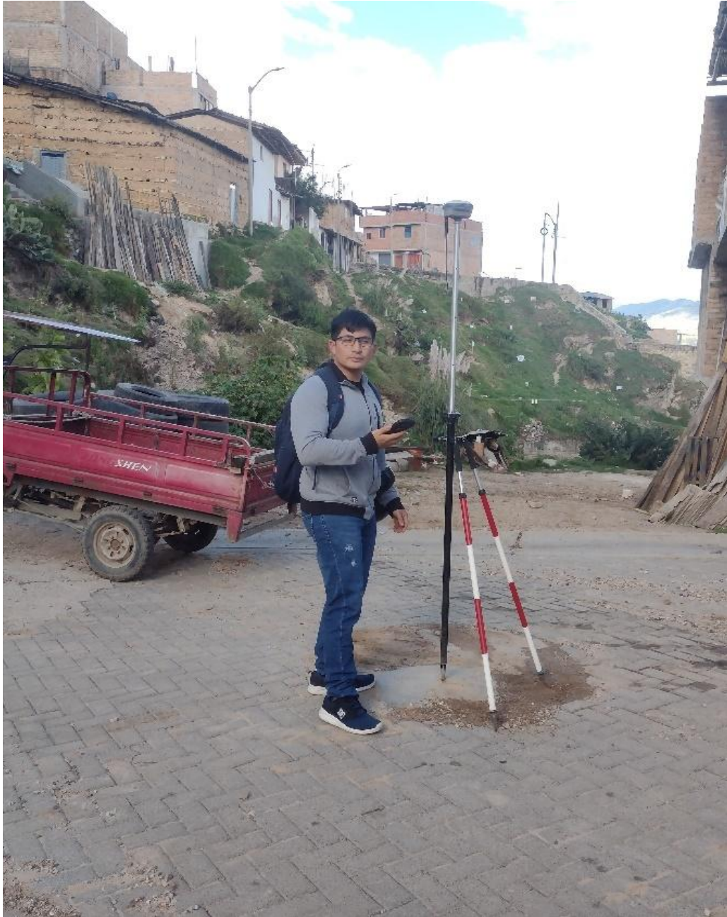
Figura 31: Colocación de Puntos de Control para fotogrametría
