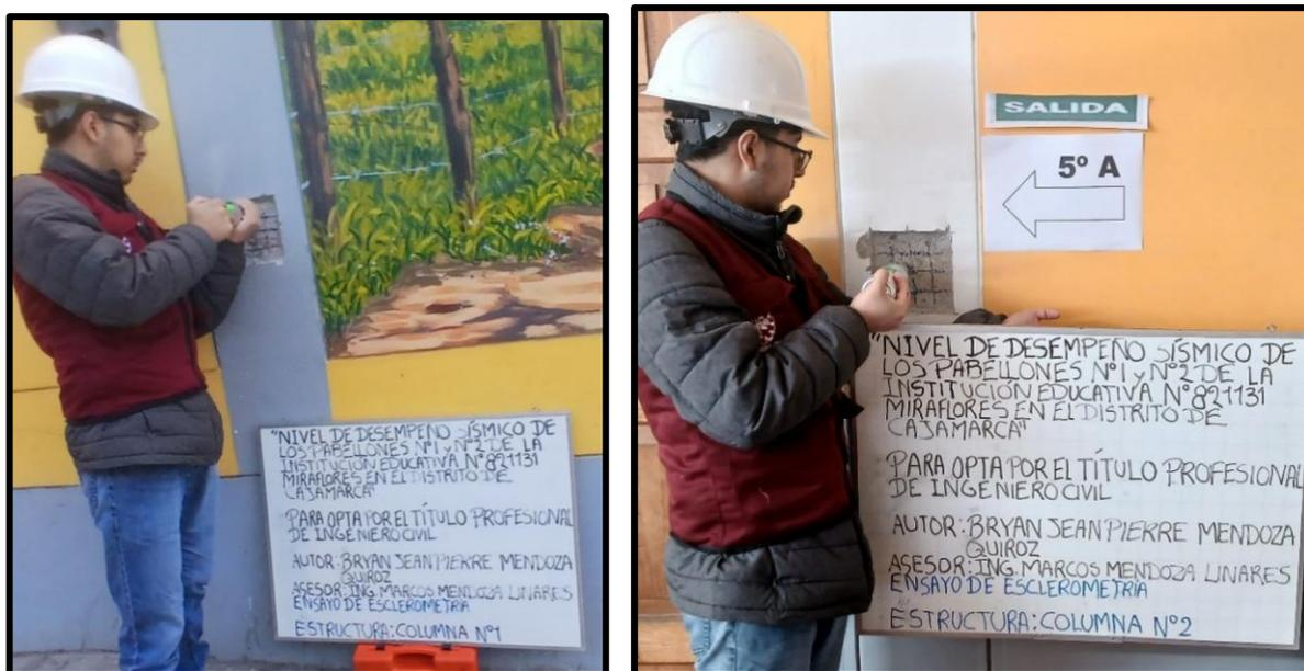
*Nota.* Fotografías tomadas realizando ensayo de esclerometría en columnas del pab. N°2, 2025.
