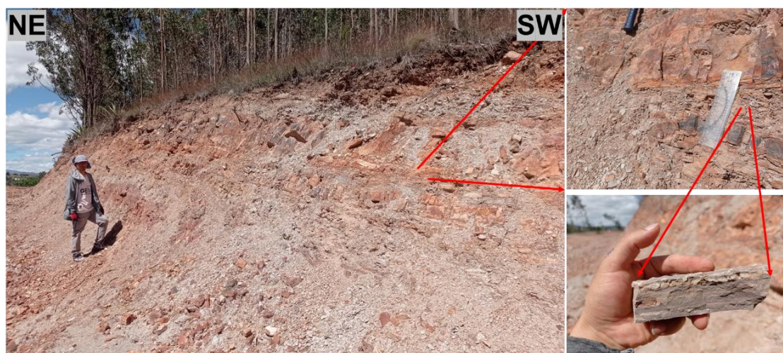
Figura 77. Afloramiento de la Fm. Farrat en corte de carretera en la parte alta del Cerro Songoles. Nota. La muestra es una arcillolita gris oscura con laminación paralela. E: 773774 N: 9213473 C: 2998.
