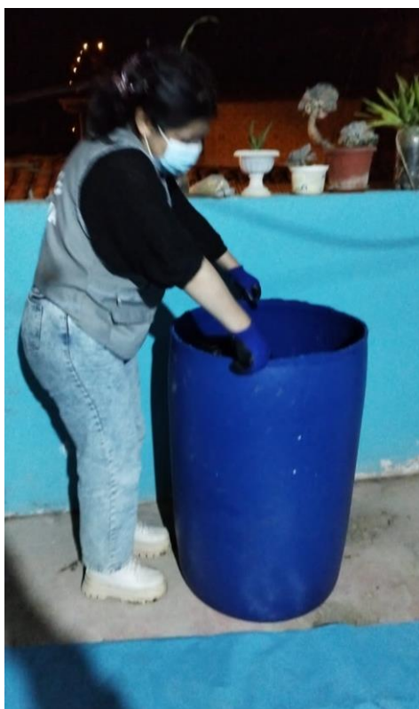
Anexo 34: Determinación de la densidad aparente mediante la compactación del cilindro con residuos sólidos previamente segregados.
