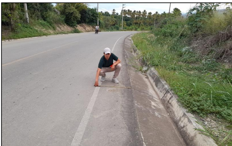
Figura 12 . Toma de medidas de la plataforma de vía cruce Shanango- Bellavista , se aprecia la media de berma en la progresiva 2+500.
