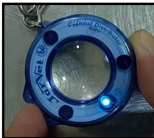
Fotografía 6: Luz cobalto. Utilizada para observar la fluoresceína reactiva en una úlcera corneal.
