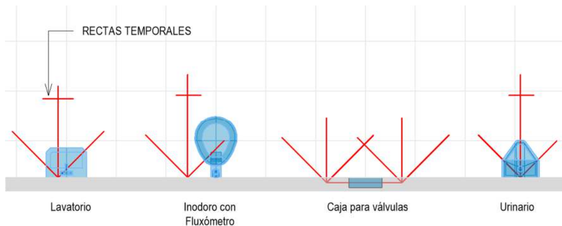
Figura 48. Ejemplo de rectas temporales generadas para distintos tipos de aparatos sanitarios
