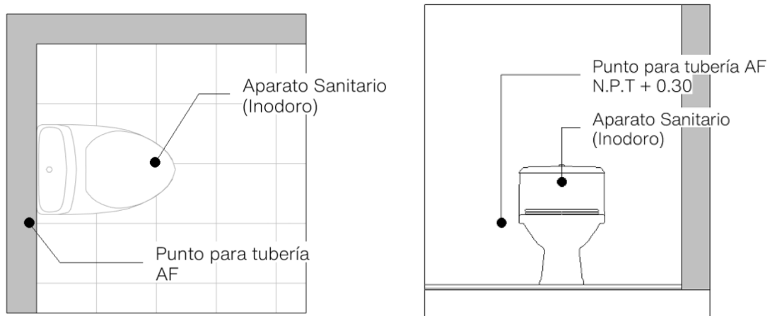
Figura 41. Ejemplo de punto de salida analítico de un inodoro con tanque
