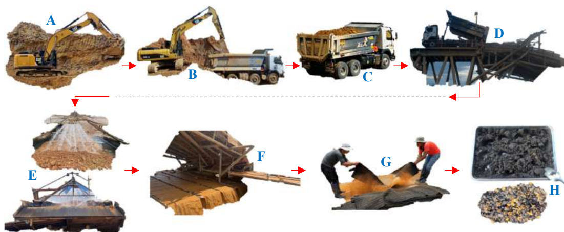
Figura 27: Proceso para la separación y concentración de minerales: A) Preparación del banco (desbroce de la cobertura vegetal, arranque de la sobrecarga y arranque del material aurífero), B) Carguío, C) Acarreo, D) Descarga de material en el chute, E) Lavado con agua a presión en la tolva del chute y clasificación granulométrica en la zaranda, F) Clasificación por densidades en las alfombras millonarias, G) Recuperación de preconcentrados mediante el sacudido de las alfombras, H) Preconcentrado final.
