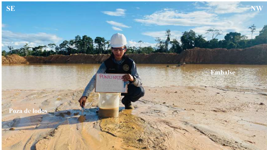
Fotografía 16: Registro del proceso de monitoreo de sedimentos limosos acumulados en las pozas de sedimentación (Raúl 1), debido a su baja densidad y tamaño de partícula fina, estos materiales son fácilmente transportados por el agua en forma de sólidos suspendidos, siendo finalmente depositados por decantación en la superficie.
