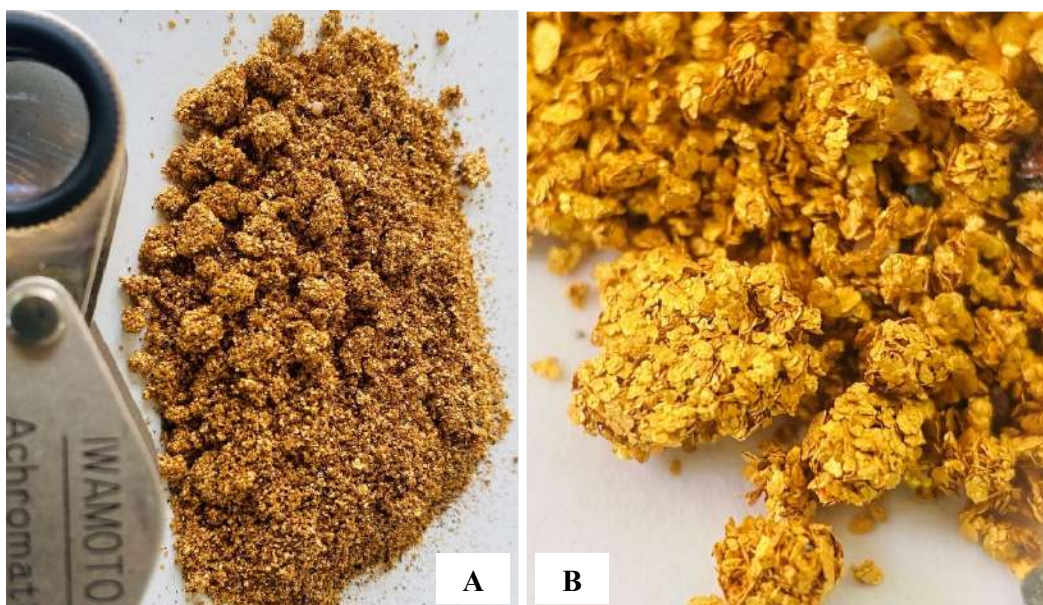
Fotografía 41: Partículas de oro nativo libre extraídas del depósito aluvial Raúl 1, A) Las partículas de oro finas tan solo alcanzan el 6 % en concentración, B) Partículas de oro homogéneas en forma y en tamaño ( > 106 \mu\text{m} ), vistas a través del lente de una lupa de aumento de 20x, al aplicar temperatura (entre 300^\circ y 500^\circ\text{C} ), las partículas de oro tienden a unirse entre ellas (sinterización).
