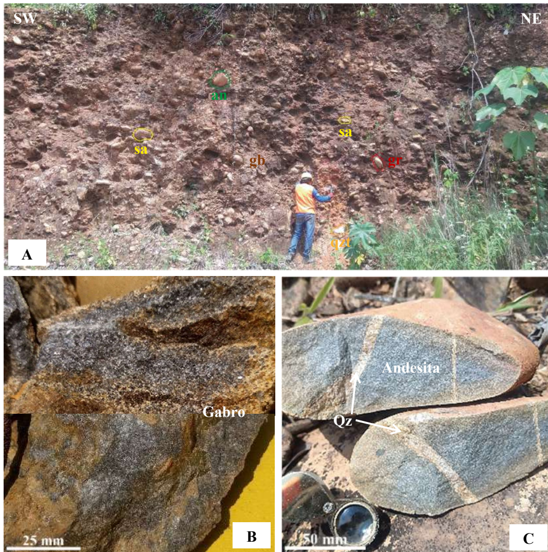
Fotografía 26: A) Sección del frente de explotación en la que la distribución y clasificación de las gravas es mal seleccionada, gravas moderadamente alteradas en una matriz arcillo – limosa consolidada, este perfil sugiere un proceso de depositación en condiciones de baja energía y una posterior alteración mineral debido a factores de meteorización, B) Fragmento de una roca ígnea plutónica (gabro), moderadamente alterada, C) Fragmento moderadamente alterado de una andesita con vetillas de óxidos de silicio (Qz).
