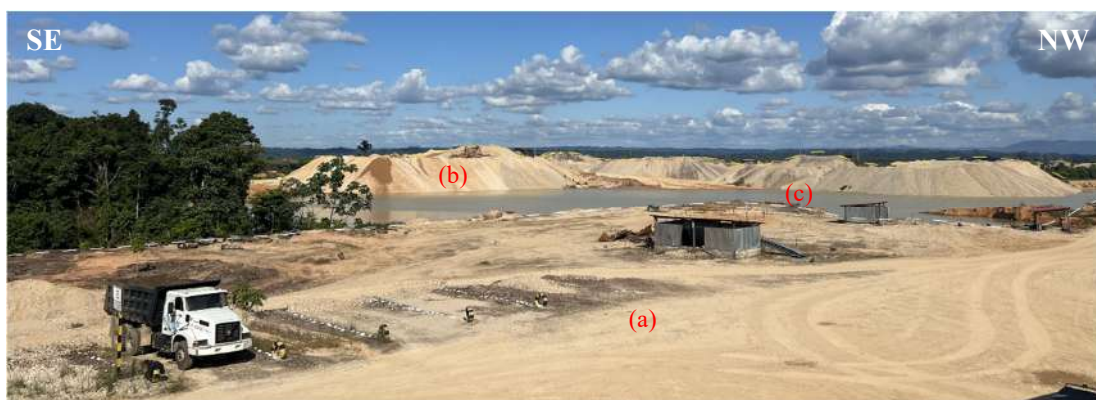
Fotografía 9: En esta fotografía se identifican plataformas horizontales (a), montículos estériles (b) y embalses (c), áreas que han sido modificadas por la actividad minera y ahora forman parte de las geoformas antropogénicas.
