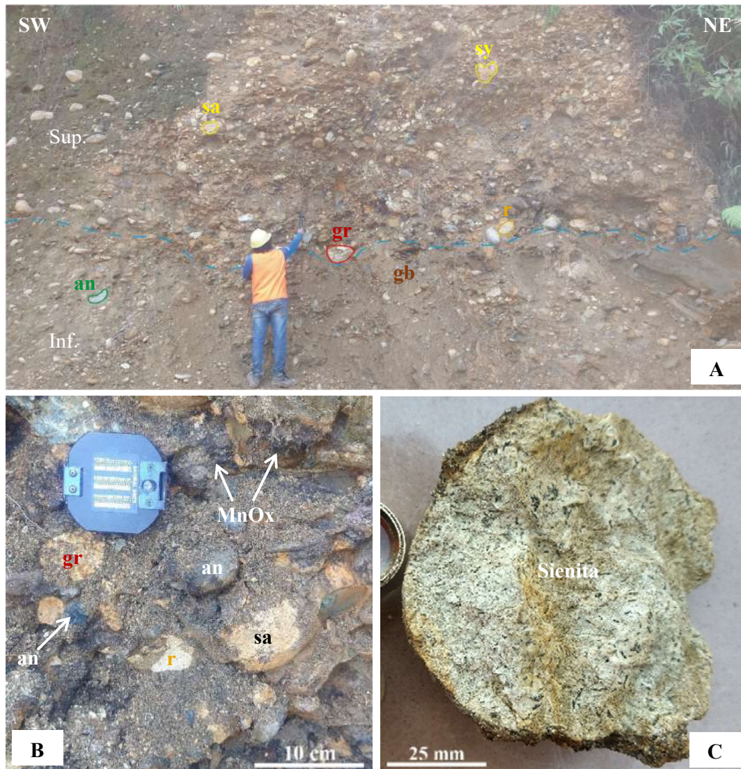
Fotografía 24: A) Sección del frente de explotación con altura aproximada de 5 metros (superior e inferior), constituida por gravas de moderadamente a bien seleccionadas, dispuestas de manera aleatoria y fuertemente compactadas dentro de una matriz de arenas, lo cual sugiere un ambiente de deposición con energía variable, B) Gravass moderadamente seleccionados y fuertemente alteradas en matriz arenosa, C) Canto de roca ígnea intrusiva (sienita) fuertemente alterada.
