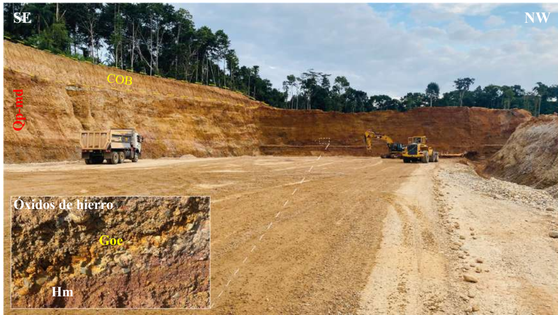
Fotografía 11: La Formación Madre de Dios (miembro inferior), compuesta por gravas y una matriz arenosa con limos y arcillas, con manchas rojizas por la oxidación (principalmente hematita y goetita), banco de aproximadamente 7 metros de altura, ubicado al margen izquierdo del río Puquiri (aguas abajo).
