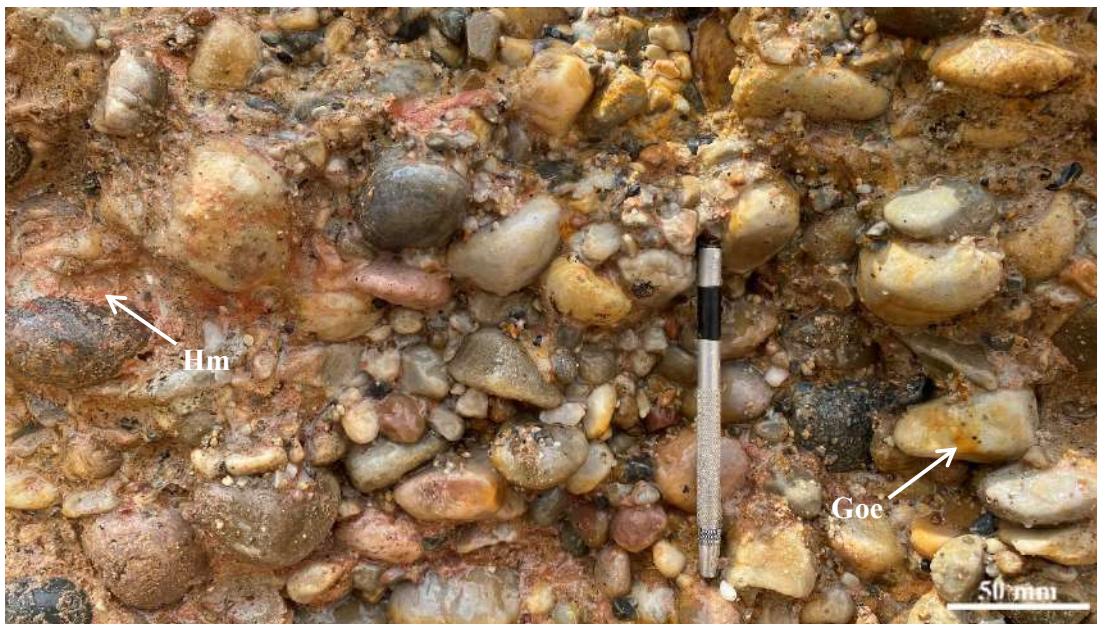
Fotografía 14: Distribución de gravas polimícticas subredondeadas a redondeadas, moderadamente seleccionadas y semiconsolidadas, con pátinas de óxidos en sus superficies, dentro de una matriz compuesta por arenas y arcillas, observada en un perfil litoestratigráfico en Raúl 1.
