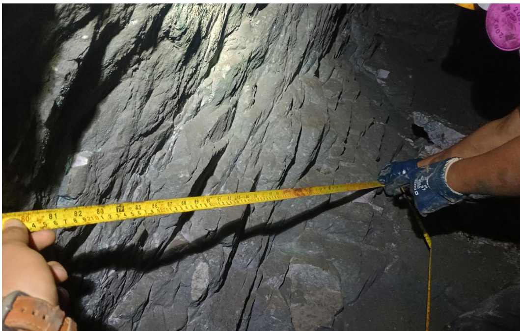
Foto 2. Medición y contabilidad de discontinuidades en la roca caja techo.
