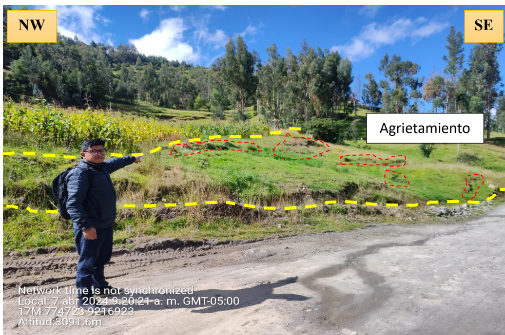
Fotografía 18. En el terreno se aprecian agrietamientos longitudinales, paralelos al escarpe principal. Coordenadas: E: 774723 N: 9216923 C: 3127 m.s.n.m.
