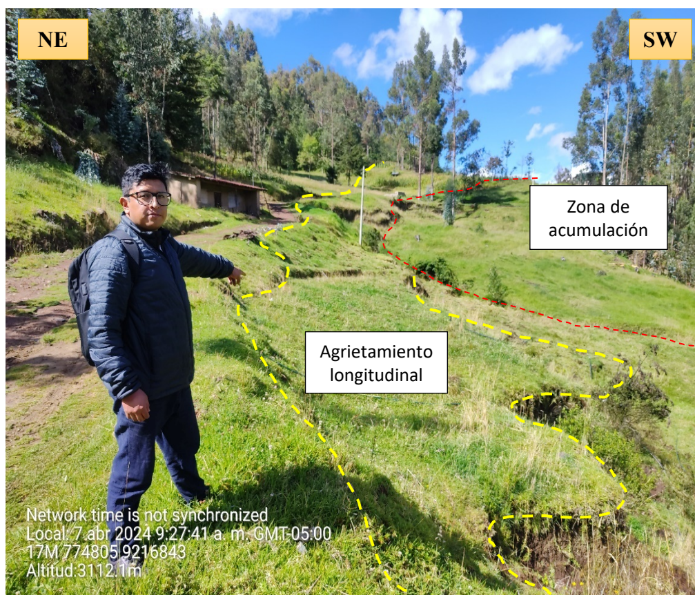
Fotografía 19. En el terreno se aprecian agrietamientos longitudinales, paralelos al escarpe principal. Coordenadas: E: 774805 N: 9216843 C: 3112 m.s.n.m.
