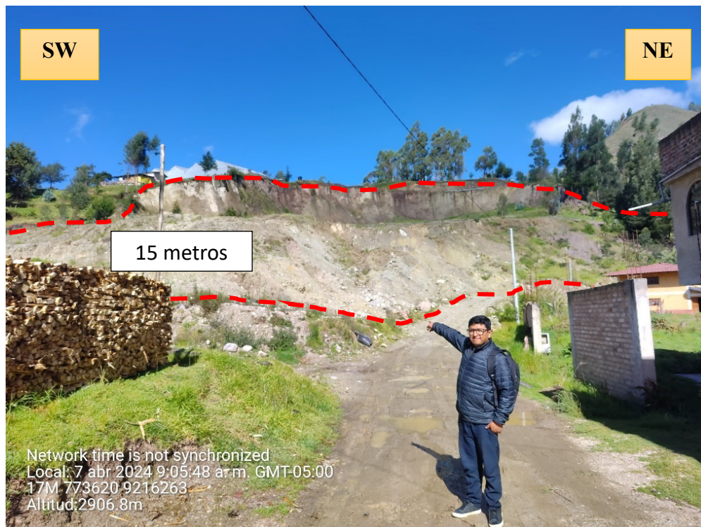
Fotografía 16. Escarpe principal con altura principal de 15 metros. Coordenadas: E: 773620 N: 9216263 C: 2906 m.s.n.m.
