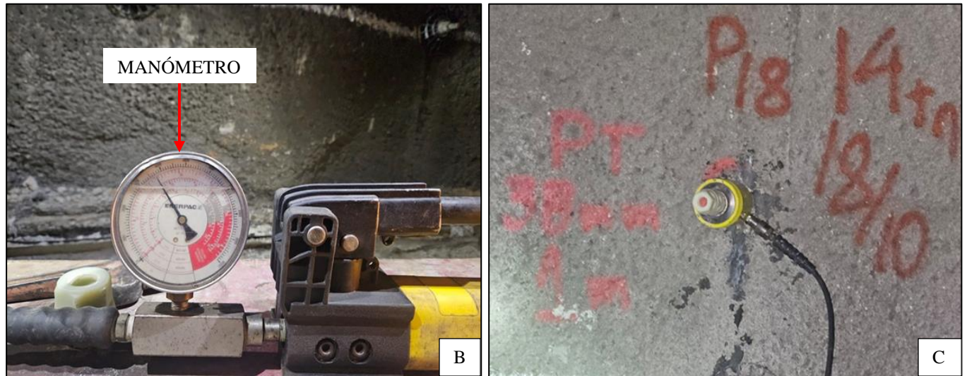
Figura 26. Manómetro marcando 14 TN de resistencia a la tracción en la progresiva PK0+060 de la RP 3750 – Chaquicocha UG
