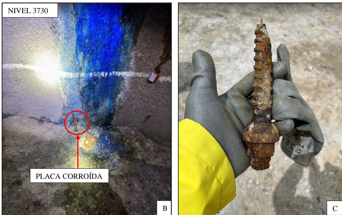
Figura 6. En la imagen de la parte izquierda se observa una placa corroída en el suelo además de presenciar una coloración anómala en el hastial producto de los sulfuros en el nivel 3730. En la imagen de parte derecha se observa un perno rebar encontrado en el piso durante una inspección en enero de 2023, este perno falló debido a la corrosión. Fuente: Turner, 2023
