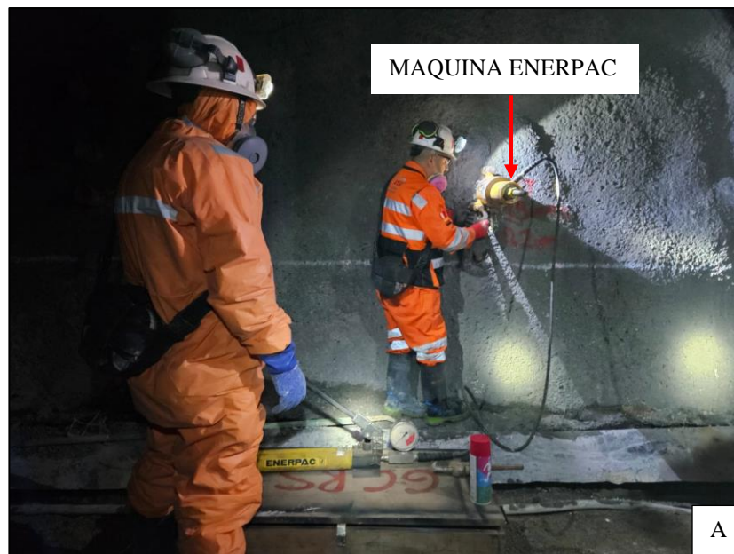
Figura 25. Ensayos de pull test aplicados a pernos de fibra de vidrio con la máquina de arranque de pernos ENERPAC
