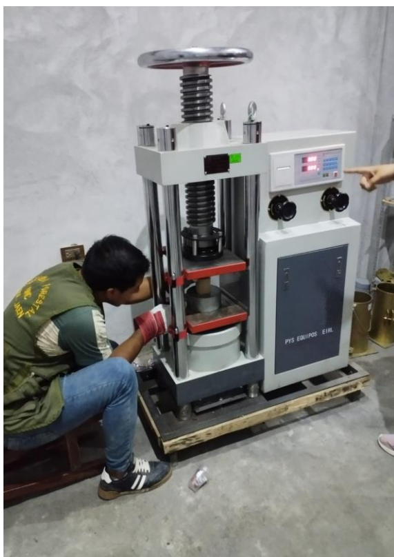
Fotos 23 y 24. Ensayo de la compresión paralela y cizallamiento de las propiedades mecánicas.
