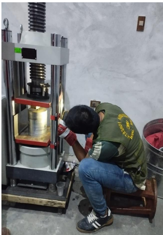
Fotos 25 y 26. Ensayo de dureza y flexión estática para propiedades mecánicas
