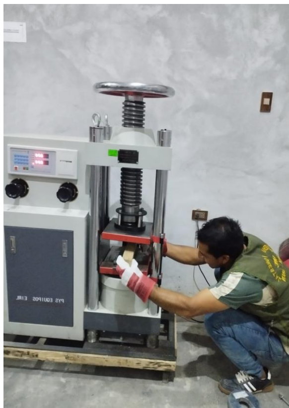
Fotos 25 y 26. Ensayo de dureza y flexión estática para propiedades mecánicas
