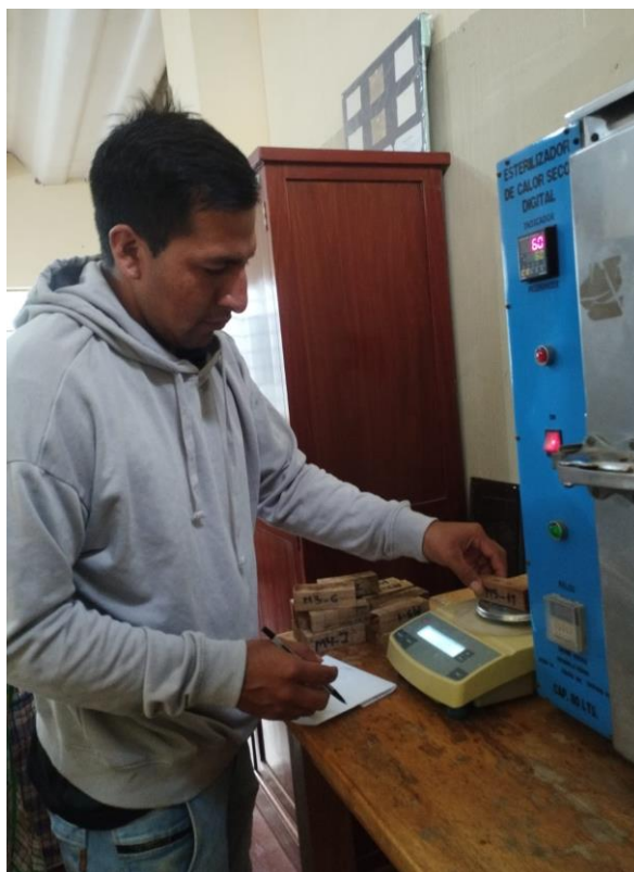
Fotos 21 y 22. Medidas, pesado y secado de la madera para propiedades físicas
