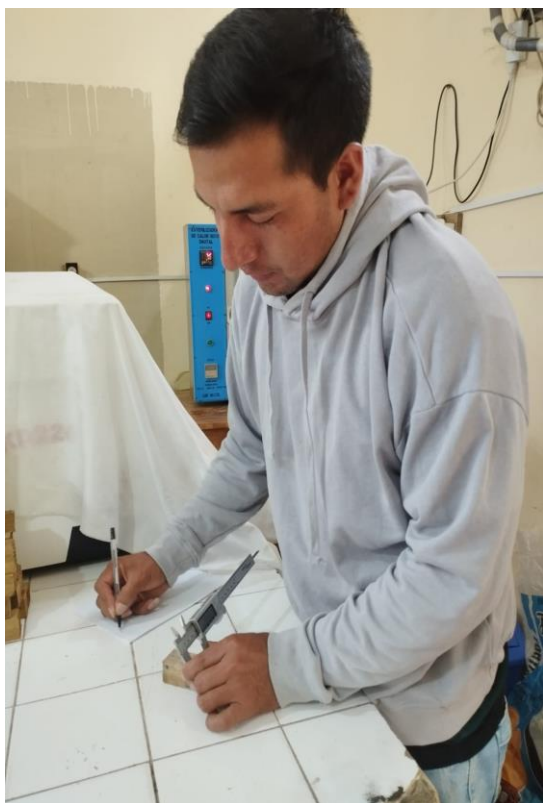
Fotos 21 y 22. Medidas, pesado y secado de la madera para propiedades físicas
