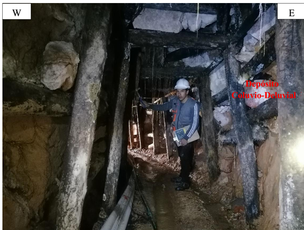
Figura 12. Sección de Galería conformada por Depósito Coluvio-Deluvial con Fragmentos de Roca Angular de Diámetro Mayor a 3 pulgadas, con Estructura Desordenada poco Compacta, en Matriz Englobante de Finos.
