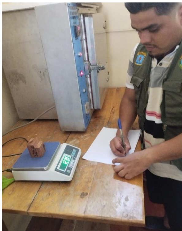
Fotos 15 y 16. Pesado y secado de las probetas para propiedades mecánicas
