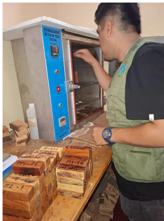
Fotos 11 y 12. Pesado y secado de las probetas de propiedades físicas
