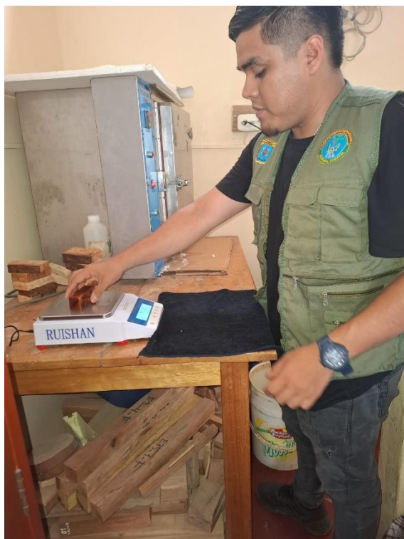
Fotos 11 y 12. Pesado y secado de las probetas de propiedades físicas
