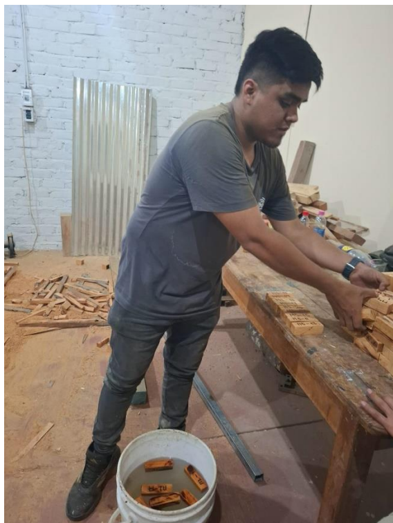
Fotos 9 y 10. Aclimatación y medición de probetas para propiedades físicas
