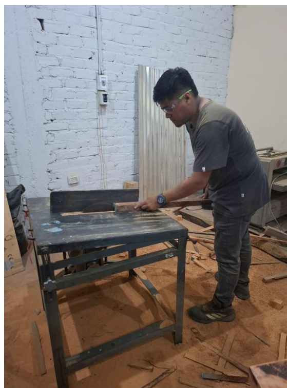
Foto 7 y 8. Elaboración de probetas en laboratorio para propiedades físicas y mecánicas
