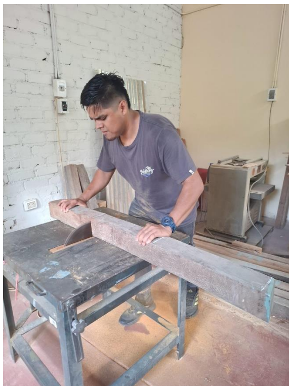
Foto 7 y 8. Elaboración de probetas en laboratorio para propiedades físicas y mecánicas
