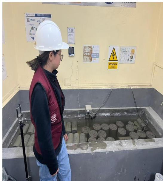
*Nota. La figura C6 muestra el procedimiento de curado de probetas. Fuente: Elaboración Propia (2024).*
