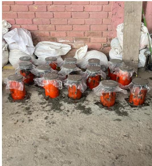
*Nota. La figura C5 muestra las probetas recién moldeadas que contienen la mezcla de concreto, listas para el proceso de curado.*
