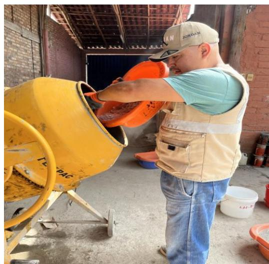
Nota. La figura C2 muestra la cantidad de fibra de plástico PET añadida a la mezcla en proporción al peso del cemento. Fuente: Elaboración propia (2024).
