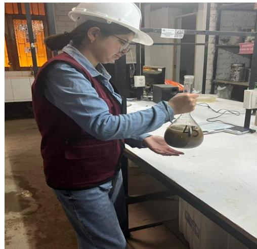
*Nota.* La figura A6 muestra el material en el picnómetro para el ensayo de gravedad específica y absorción del agregado fino. Fuente: Elaboración Propia (2024)
