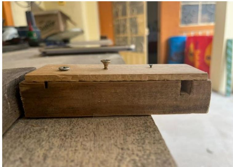
Nota. La figura B11 muestra la vista en alzado del segundo prototipo de corte de fibra de plástico PET, diseñado para obtener un largo de 3 cm. Fuente: Elaboración propia (2024).
