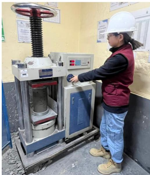
*Nota.* La figura C7 muestra el procedimiento de rotura de probetas. Fuente: Elaboración Propia (2024).
