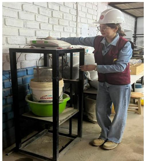
*Nota.* La Figura A5 muestra el material sumergido en agua para el ensayo de peso específico y absorción del agregado grueso. Fuente: Elaboración Propia (2024)
