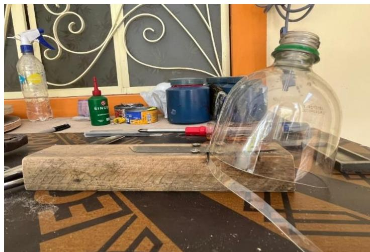
*Nota.* La figura B6 muestra la vista en planta del primer prototipo de corte de fibra de plástico PET, diseñado para obtener un ancho de 0.5 cm. También se muestran los materiales utilizados para su elaboración y obtención. Fuente: Elaboración propia (2024).
