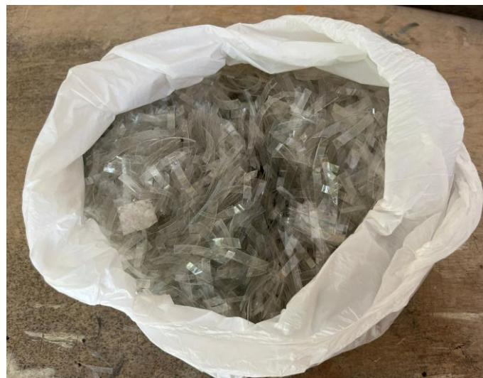
*Nota.* La figura B14 muestra la Cantidad de fibra de plástico PET utilizada en el diseño de mezcla, con un total de 2.72 kg, considerando un 10 % de desperdicio. Fuente: Elaboración propia (2024)
