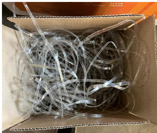
*Nota.* La figura B8 muestra la fibra de plástico PET obtenida, con un ancho de 0.5 cm. Fuente: Elaboración propia (2024).
