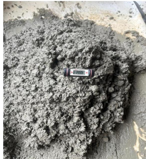
*Nota. La figura C4 muestra el registro de la temperatura del concreto fresco durante su elaboración, utilizando un termómetro digital.*
