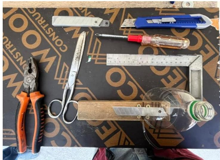
*Nota.* La figura B5 muestra la vista en planta del primer prototipo de corte de fibra de plástico PET, diseñado para obtener un ancho de 0.5 cm. También se muestran los materiales utilizados para su elaboración y obtención. Fuente: Elaboración propia (2024).
