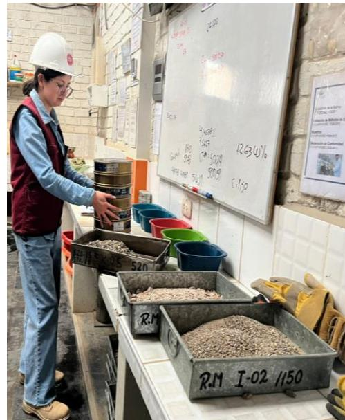
*Nota. La figura A3 muestra el tamizado de agregados para el ensayo de análisis granulométrico. Fuente: Elaboración Propia (2024)*
