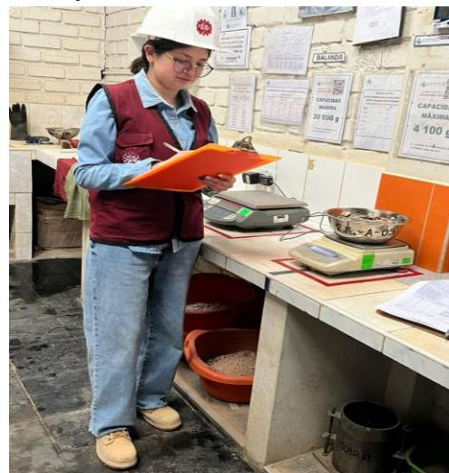
*Nota.* La figura A2 muestra el pesaje de taras con agregado grueso como parte del procedimiento para determinar el contenido de humedad. Fuente: Elaboración Propia (2024)
