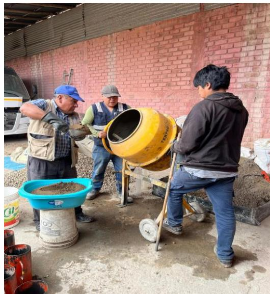
Nota. La figura C1 muestra el material agregado a la mezcladora para la elaboración de las probetas con mezcla de concreto. Fuente: Elaboración propia (2024)
