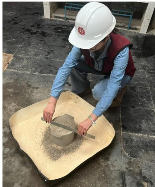
*Nota. La figura A4 muestra el enrasado del material fino para el ensayo de peso unitario compactado del agregado fino. Fuente: Elaboración Propia (2024)*
