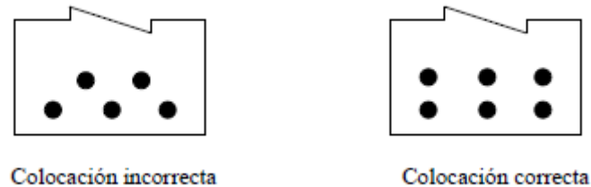
Figura 5. Colocación de la Armadura Principal en Dos Filas.
