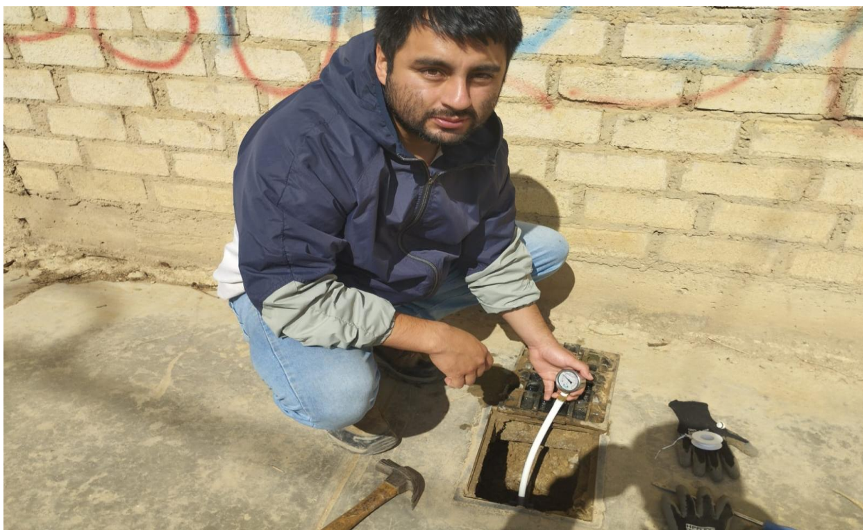
Figura 30. Medición de presión en caja de registro barrio Bellavista.
