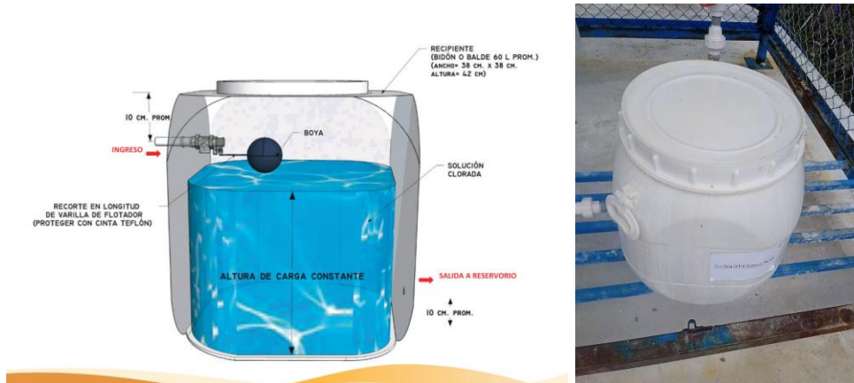
Figura 3: Instalación del recipiente dosificador
