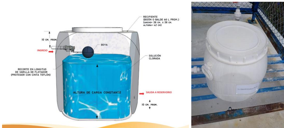
Figura 3: Instalación del recipiente dosificador
