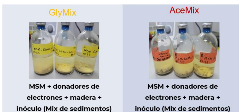
Figura 16. Muestra fotografías de los microcosmos formados con sus respectivos donadores de electrones GlyMix (glicerol) y AceMix (acetato).
