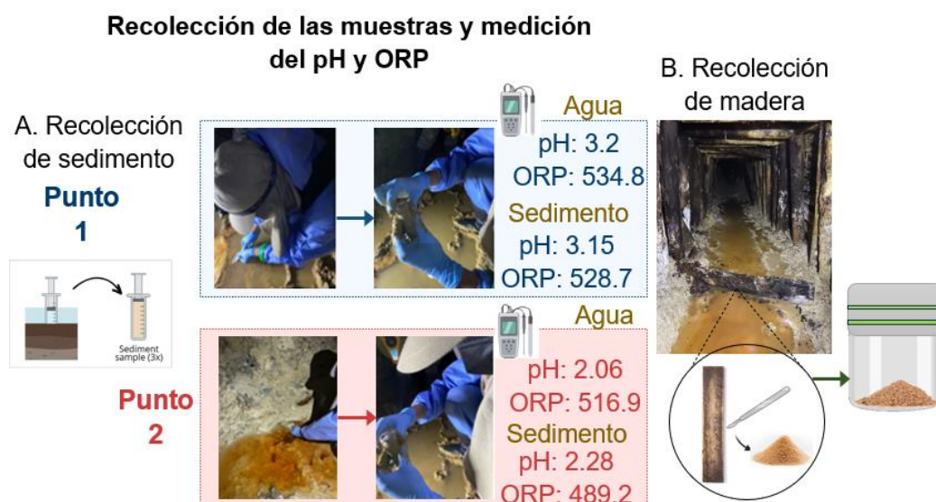
Figura 13. Muestra el proceso de recolección de las muestras de sedimento y madera, así como la medición de los parámetros fisico-químicos del agua in situ . (A). recolección del sedimento en el P1 y P2. (B) recolección de madera en el P2.
