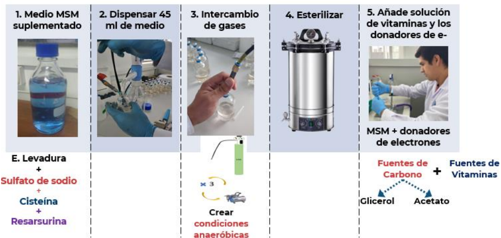
Figura 14. Preparación del medio. (1) agregar las soluciones stock. (2) Dispensar el líquido preparado en frascos de suero de 100 mL. (3) realizar el intercambio de gases ( N_2/CO_2 : 80/20). (4) Esterilizar el medio dispensado en una autoclave. (5) Añadir la solución de vitaminas y el donador de electrones a cada botella.
