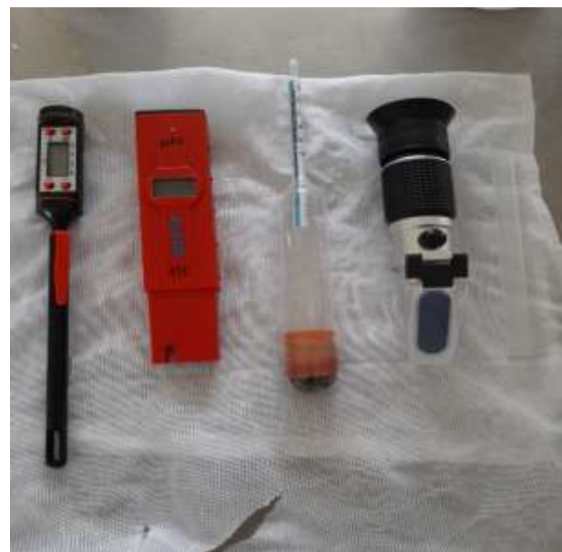
Termómetro, pH metro, termómetro de canastilla, refractómetro
