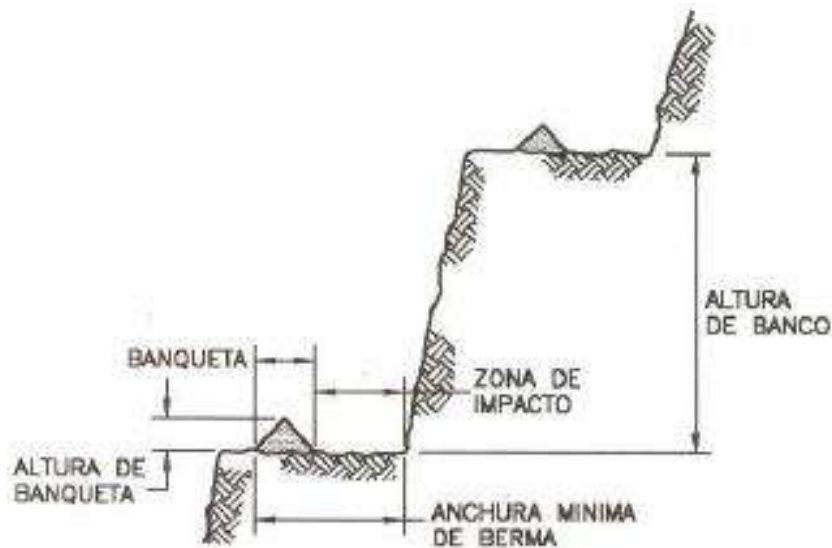
Figura 2.10. Diseño de banquetas de protección frente a desprendimientos. Fuente: Tomado de Escavy et al. 1997.
