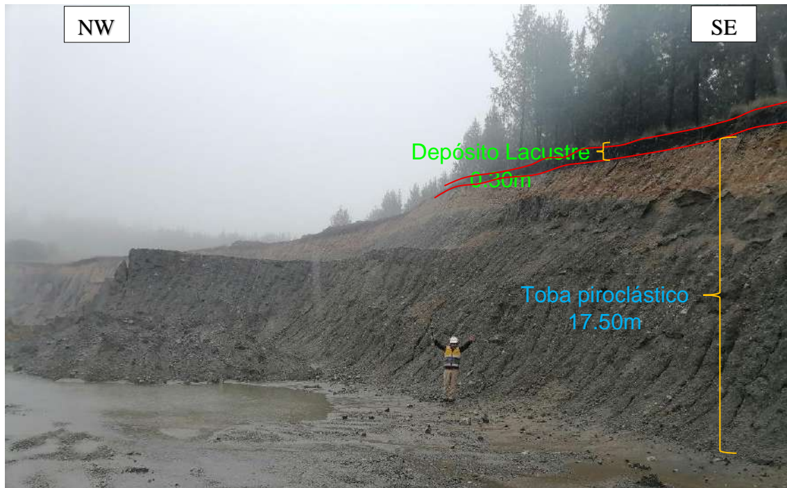
Figura 4.3. Perfil estratigráfico de la parte superior del tajo, evidenciándose Depósito Lacustre de 0.30 m. y toba piroclástica 17.50 m.
