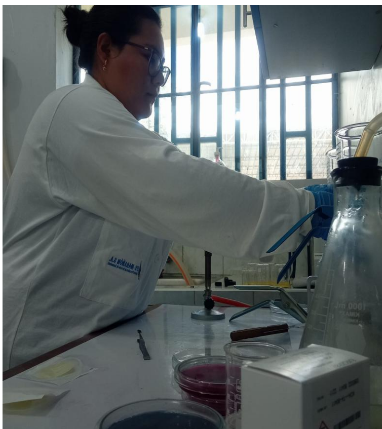
Fotografía 8. Análisis para la determinación de sólidos totales suspendidos.
