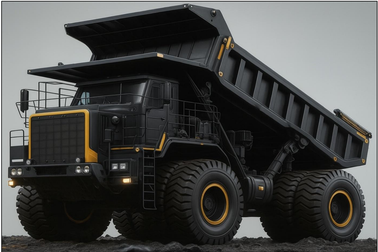
Figura 5. Dumper extraval de chasis rígido de 26 m 3 y carga útil de 40 toneladas
