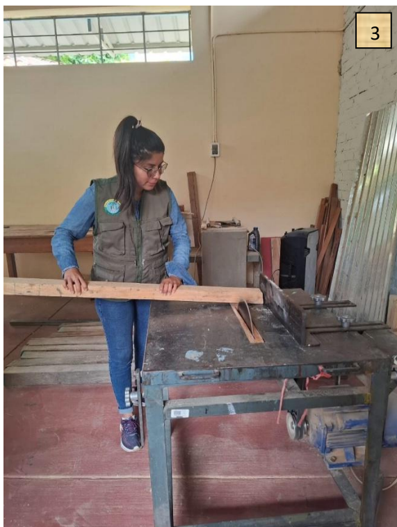
Foto 3 y 4. Elaboración de probetas en laboratorio para propiedades físicas y mecánicas
