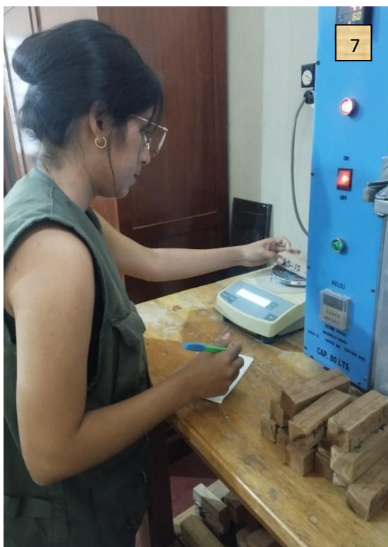
Foto 7 y 8. Pesado y secado de las probetas de propiedades físicas
