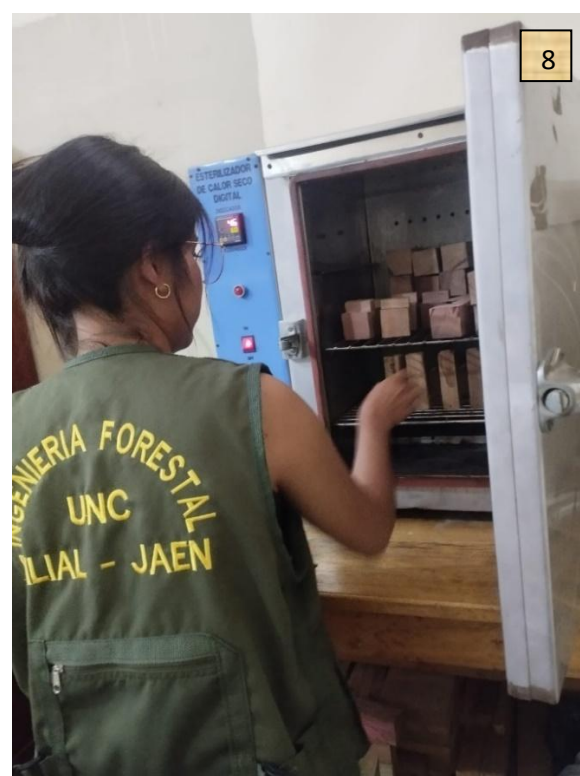
Foto 7 y 8. Pesado y secado de las probetas de propiedades físicas
