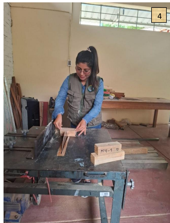
Foto 3 y 4. Elaboración de probetas en laboratorio para propiedades físicas y mecánicas
