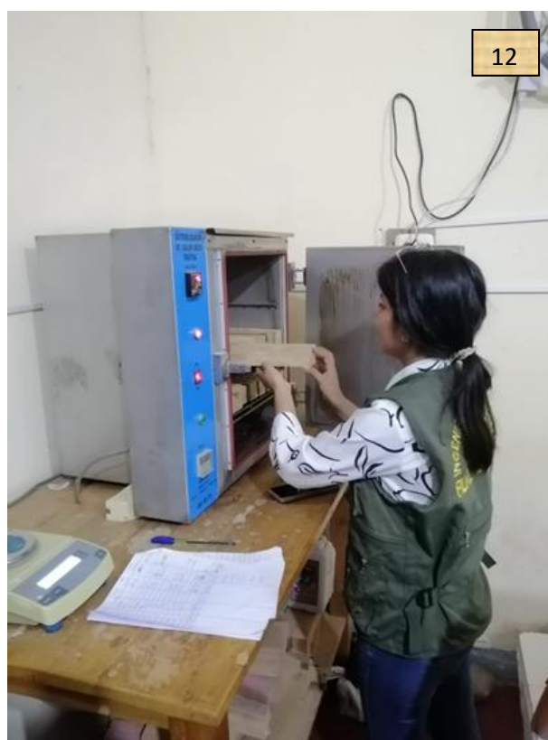
Foto 11 y 12, peso y secado de las muestras de propiedades mecánicas
