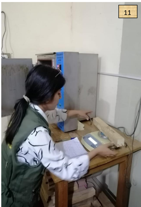
Foto 11 y 12, peso y secado de las muestras de propiedades mecánicas
