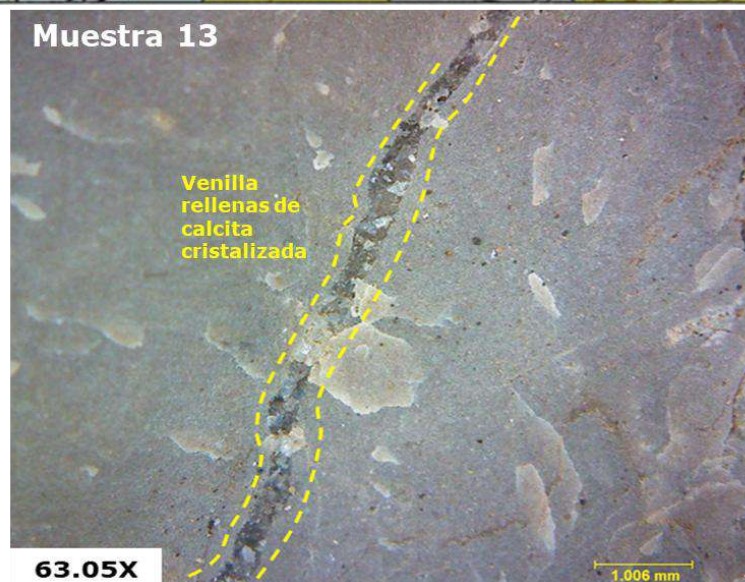
Figura 26. Calizas Mudstone de la Formación Cajamarca al microscopio con mínima cantidad de clastos.
