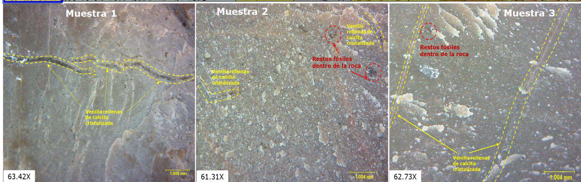
Figura 23. Calizas Mudstone de la Formación Cajamarca al microscopio con mínima cantidad de clastos.
